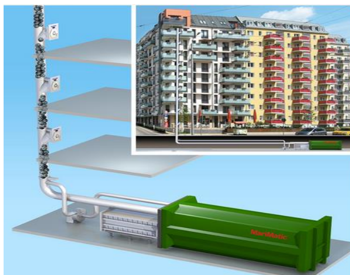
Slika 7. Postrojenje za pneumatski transport otpada [11]
