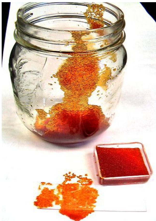
Slika 3. Ionska smola koja se nabavlja u obliku zrnaca promjera 0,1 do 1 mm. (preuzeto s www.wikipedia.hr )
