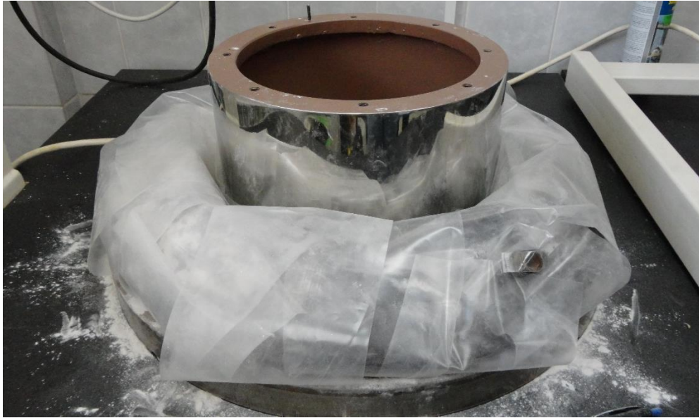
Slika 7. Gumena membrana posipana talkom i omotana HDPE folijom
