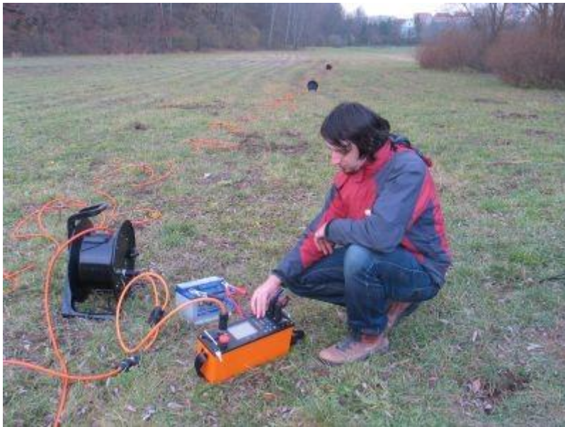
Slika 11. Prikaz geoelektričnog istraživanja [15]
