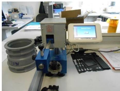
Slika 44. Uređaj za mjerenje odbojne elastičnosti
