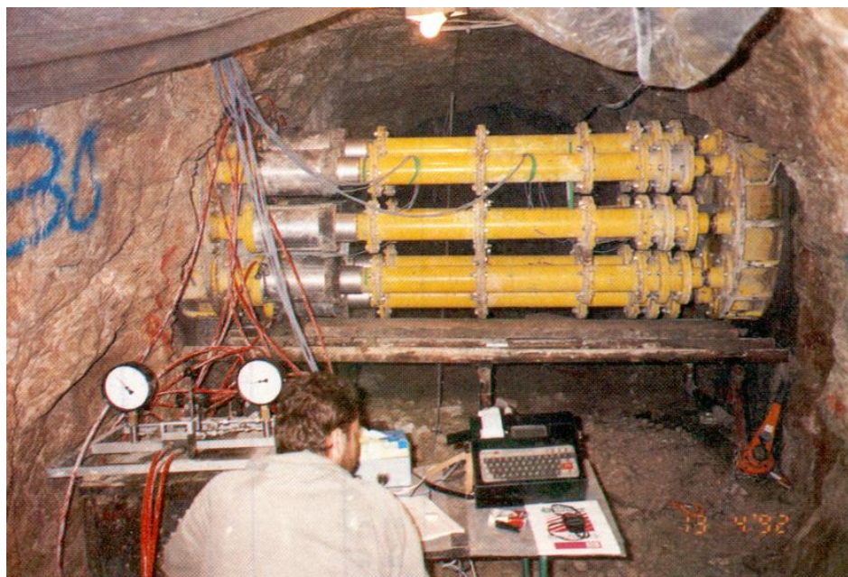
Slika 6. Horizontalni pokus (Karun 3, 1992)
