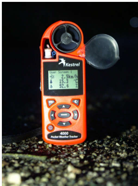
Slika 6.1 Uređaj za praćenje mikroklimatskih uvjeta
