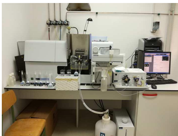
Slika 7. Atomski spektrometar tvrtke Perkin Elmer Analyst 800
