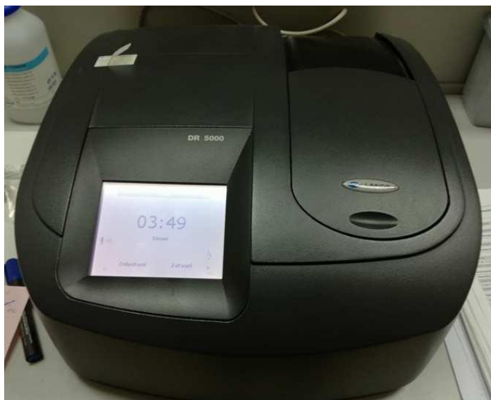
Slika 6. UV/VIS spektrofotometar tvrtke HACH LANGE
