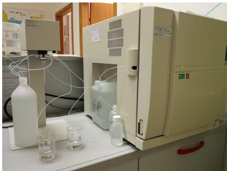
Slika 8. TOC analizator tvrtke Shimadzu
