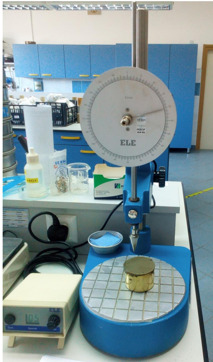
Slika 19. Određivanje granice tečenja pomoću konusnog penetrometra
