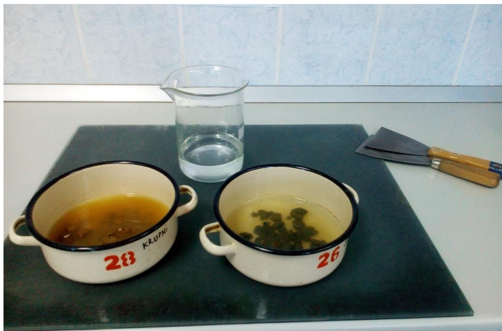
Slika 23. Priprema uzorka za areometriranje
