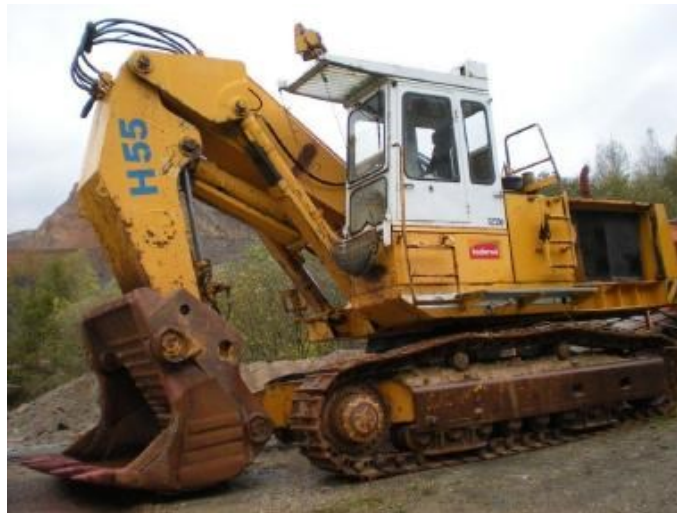
Slika 4.2 Hidraulički bager sa visinskom lopatom [14].
