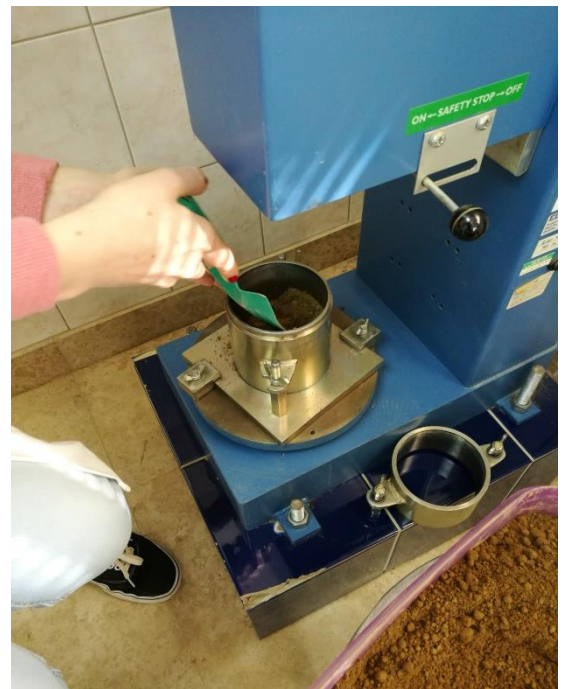
Slika 21. Punjenje cilindričnog klipa s uzorkom
