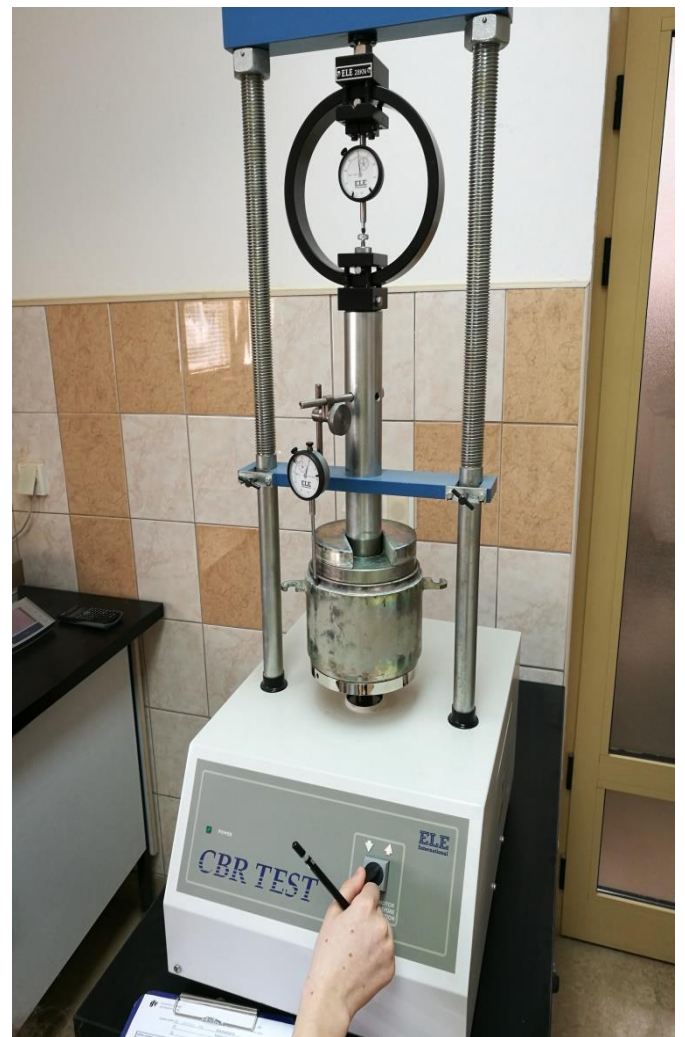
Slika 34. Izvođenje CBR pokusa
