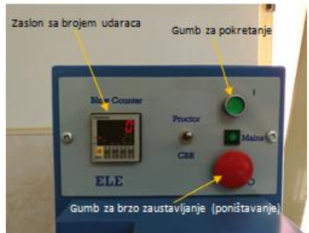
Slika 14. Kontrolna ploča na Proctor-ovom uređaju
