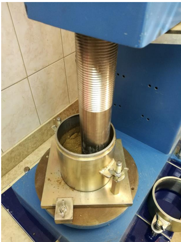
Slika 22. Zbijanje uzorka tla
