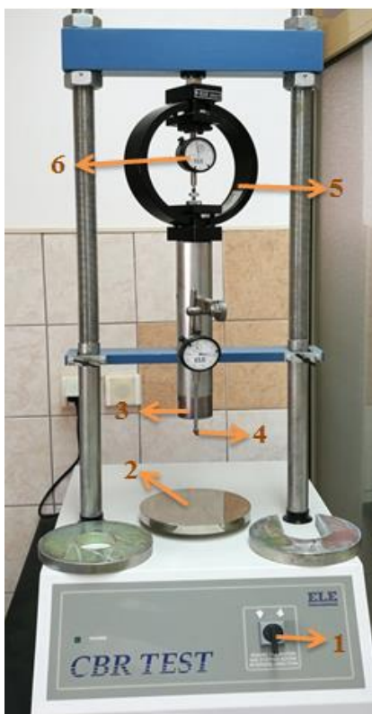
Slika 16. Uređaj za CBR pokus u laboratoriju
