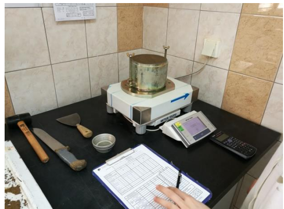
Slika 31. Vaganje zbijenog uzorka tla s cilindričnim kalupom
