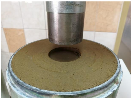
Slika 35. Uzorak tla nakon utiskivanja klipa
