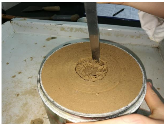
Slika 36. Vađenje uzorka za određivanje vlažnosti
