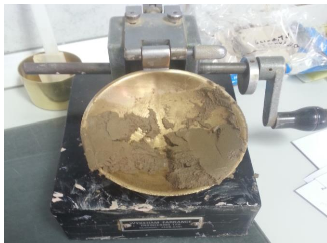
Slika 18. Problem kod određivanja granice tečenja do 35 %
