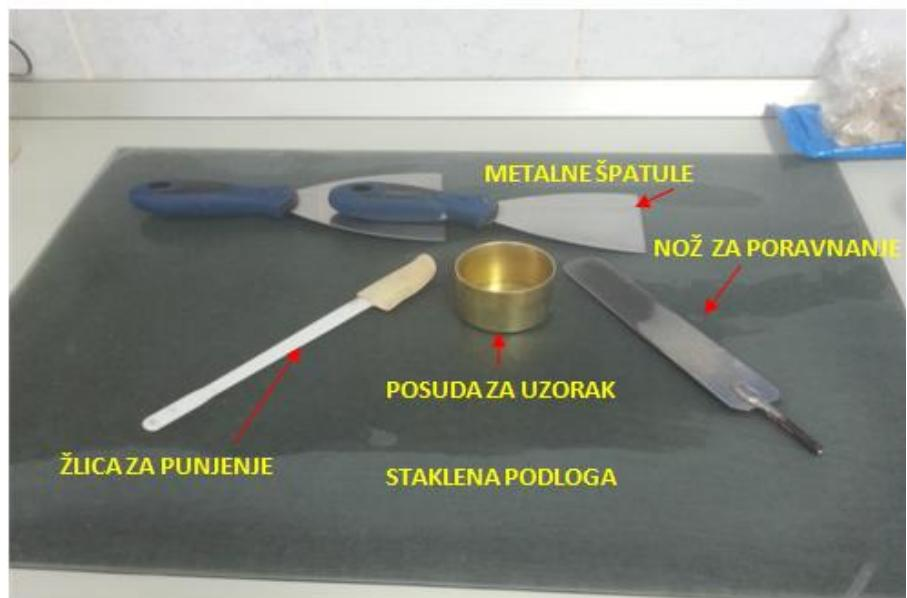
Slika 10. Oprema za određivanje granice tečenja padajućim šiljkom
