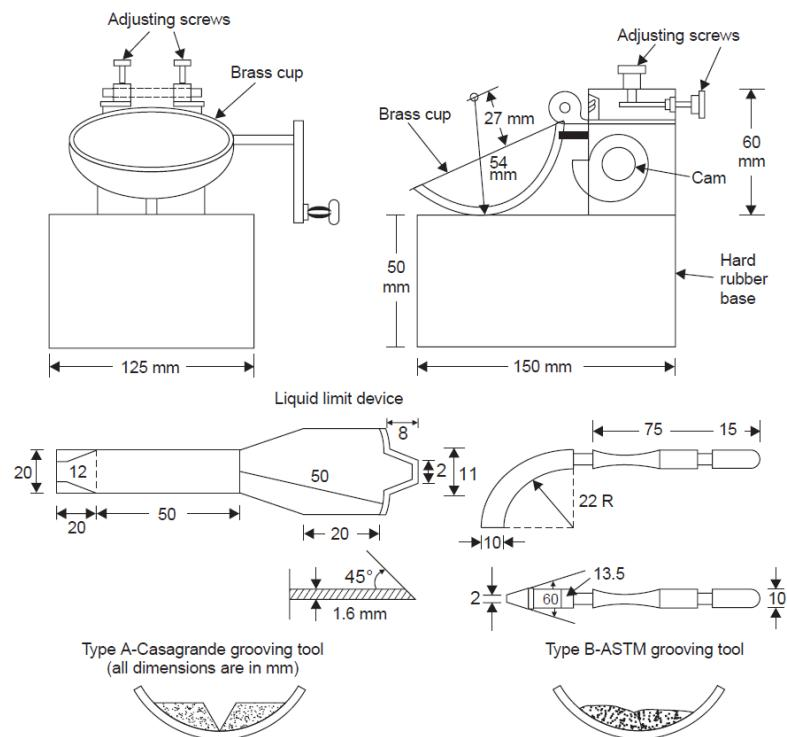
Slika 6. Dimenzije pojedinih dijelova Casagradeova aparata [10]
