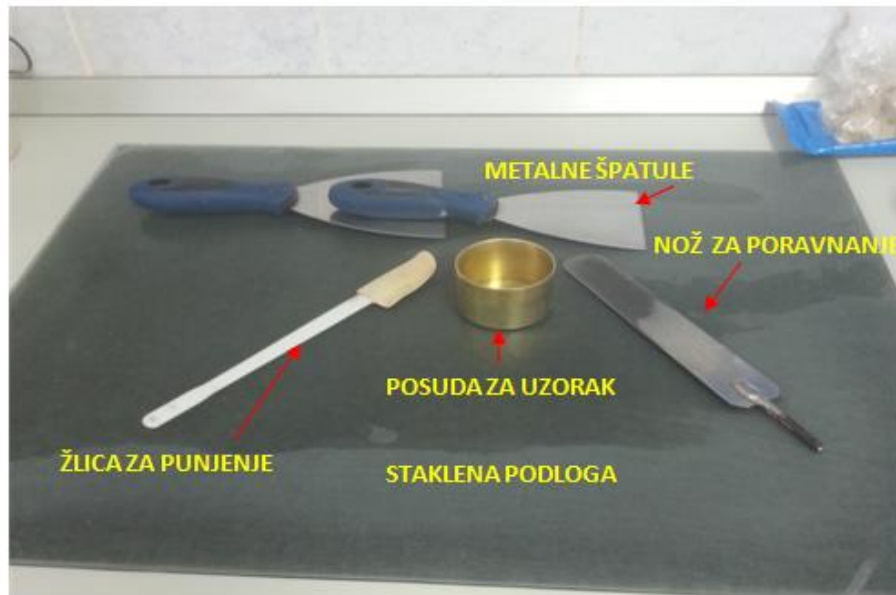
Slika 10. Oprema za određivanje granice tečenja padajućim šiljkom
