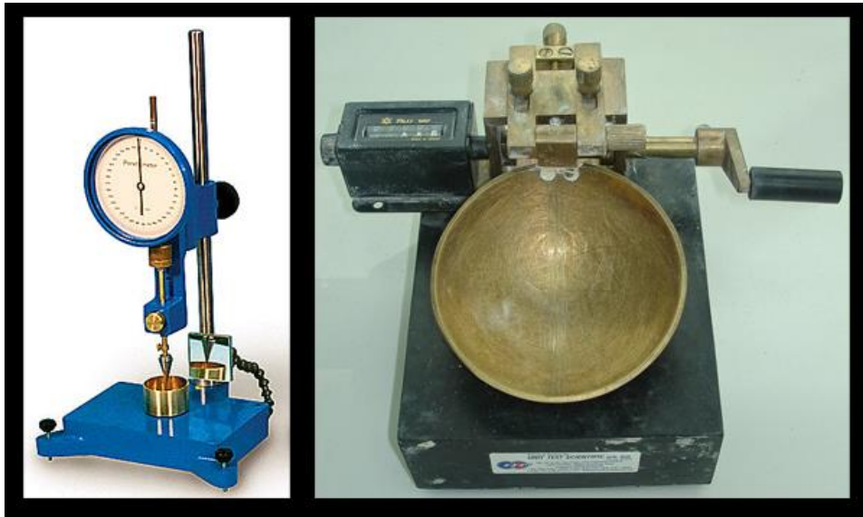
Slika 5. Aparati za određivanje granice tečenja (desno: Casagrandeov aparat, lijevo: padajući šiljak) [9]
