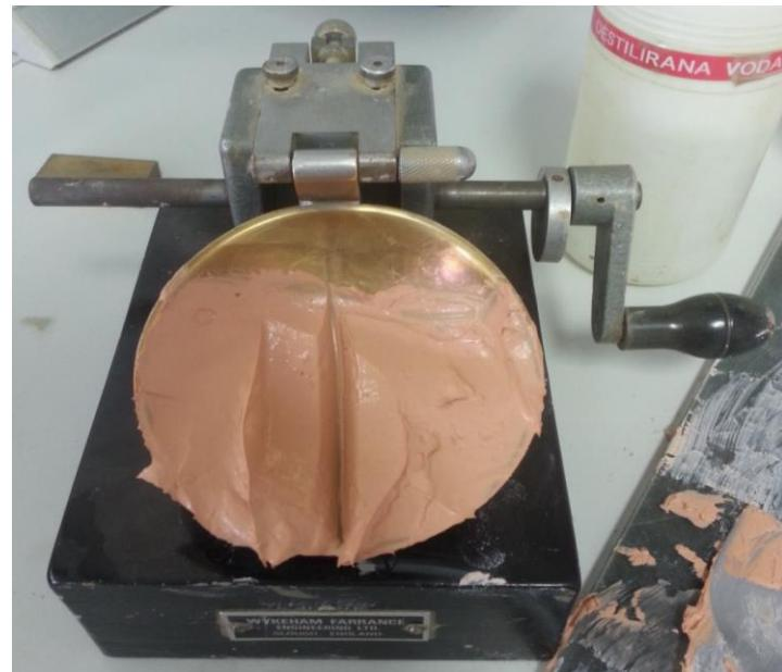
Slika 16. Uzorak podijeljen na 2 dijela nožićem za brazdu
