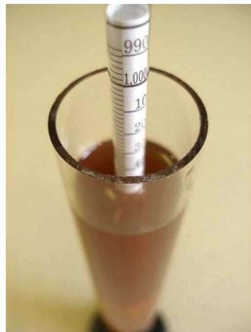
Slika 4. Areometar u suspenziji [8]
