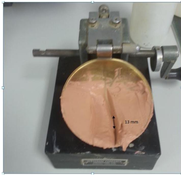
Slika 17. Spojeni uzorak za određen broj udaraca
