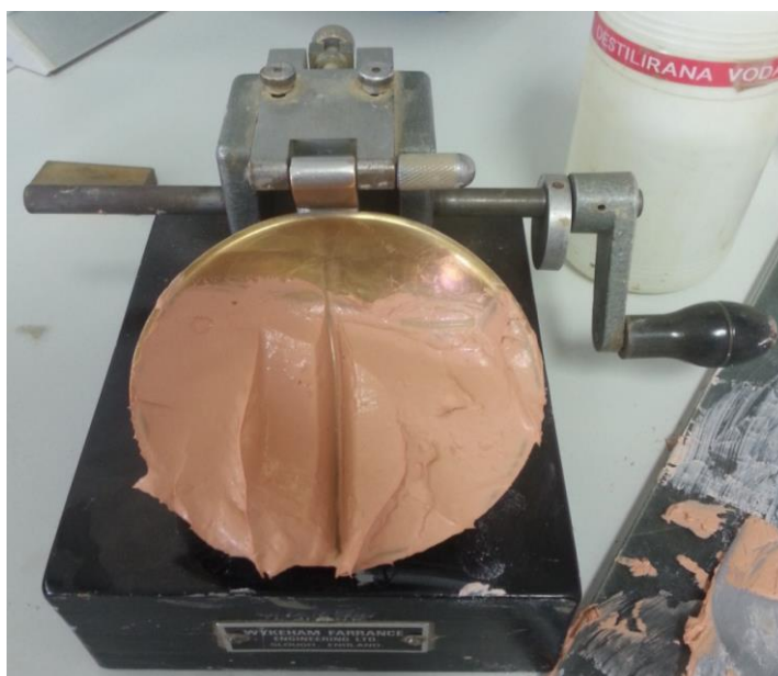
Slika 16. Uzorak podijeljen na 2 dijela nožićem za brazdu
