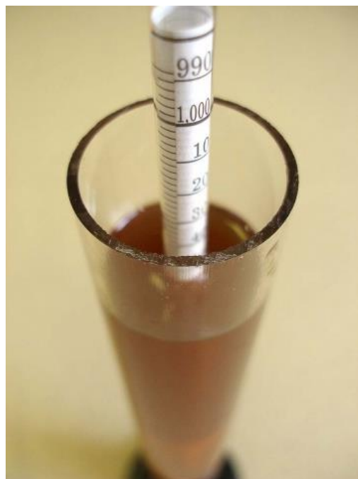
Slika 4. Areometar u suspenziji [8]
