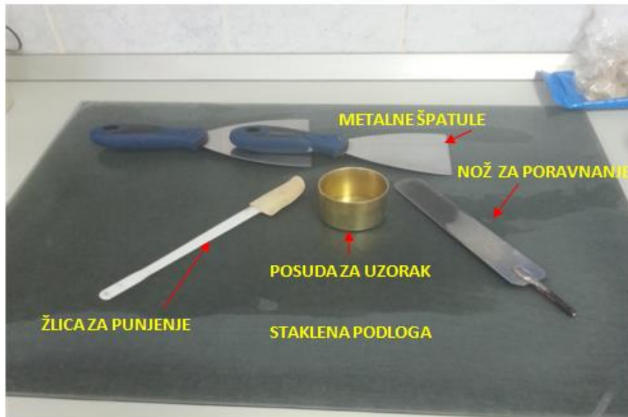
Slika 10. Oprema za određivanje granice tečenja padajućim šiljkom
