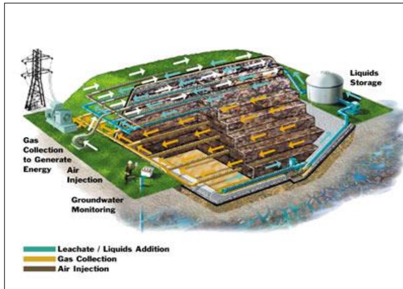
Slika 6. Hibridno bioreaktorsko odlagalište (Repa 2003)
