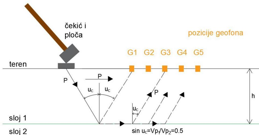
Slika 13. Princip terenskog mjerjenja brzina seizmičkih valova
