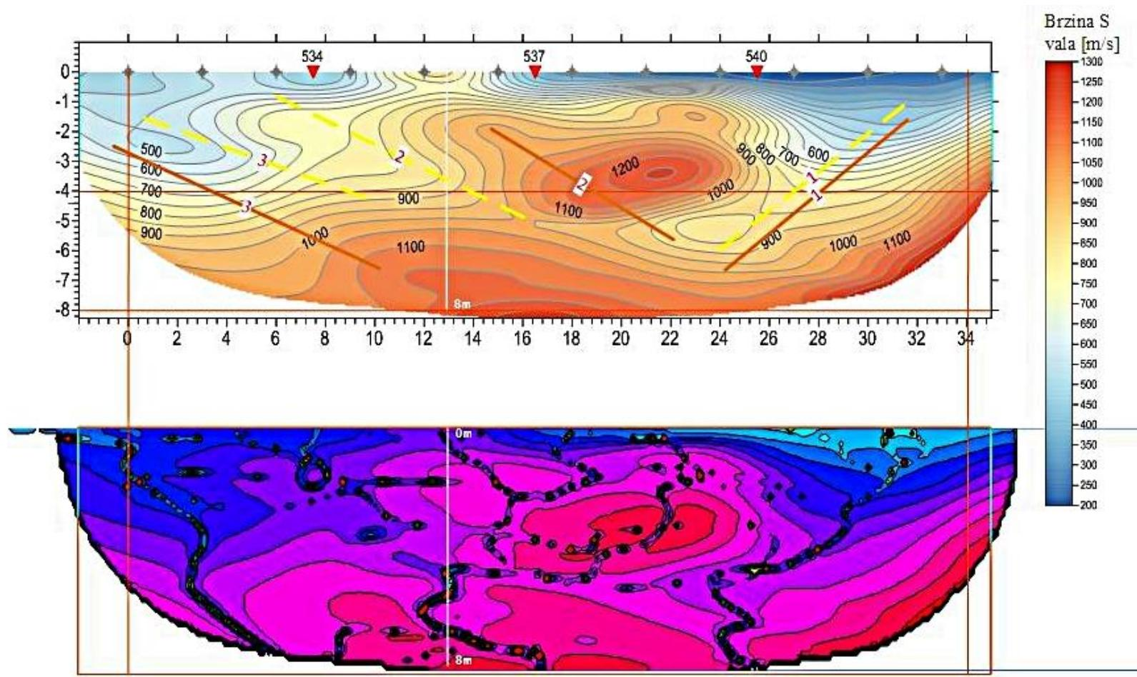
Slika 20. Gornji dio slike prikazuje profil refrakcijske tomografije s raspodjelom brzina poprečnih S valova , a donji dio rekonstrukciju seizmičke slike indeksa seizmičke kvalitete SQI na kosini
