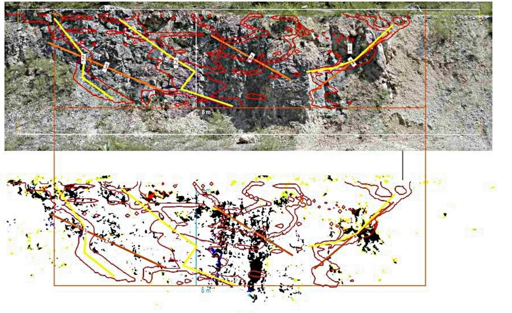
Slika 23. Usporedba slike čela kosine sa nepravilnostima i diskontinuitetima te slike svjetlosnog otiska čela (refleksa svijetlosti)
