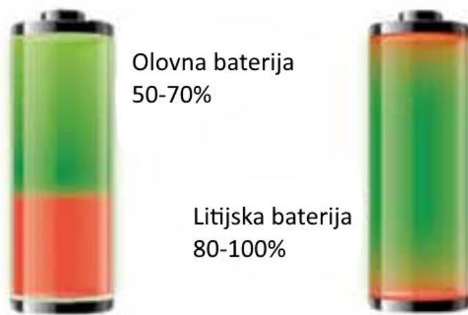
Slika 6 Iskoristivost energije iz olovnih i Li-ionskih baterija - usporedba [17]
