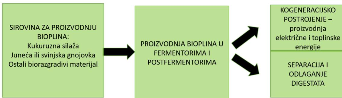
Slika 7. Shema procesa proizvodnje električne i toplinske energije
