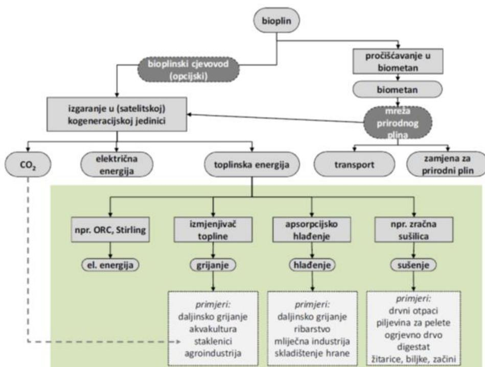
Slika 9. Mogućnosti korištenja toplinske energije iz bioplina
