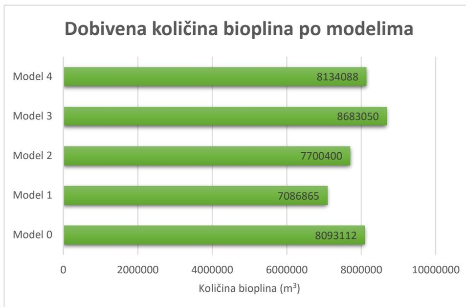
Kod Model 3 i 4 vidljivo je povećanje proizvodnje bioplina na temelju zamjene supstrata ili zamjene omjera navedenih supstrata. Model 3 ima vidljivo najveću dobivenu količinu
