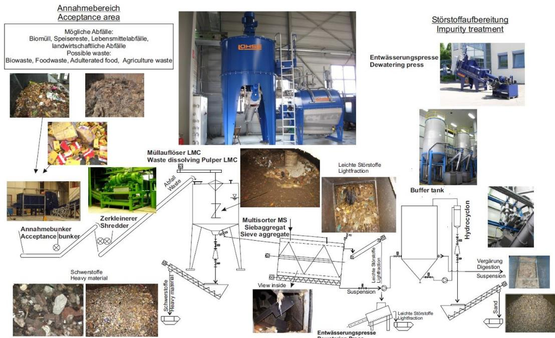
Slika 11. Shematski prikaz postrojenja za higijenzaciju biorazgradivog otpada
