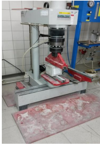
Slika 10. Ispitivanje vlačne čvrstoće betona
