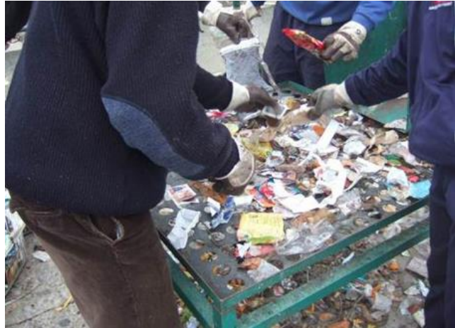
Slika 18. Ručno sortiranje komunalnog otpada na perforiranom stolu [40]
