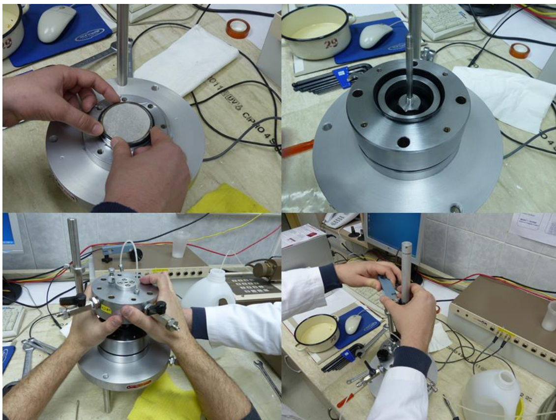
Slika 10. Postupak ugrađivanja uzorka u hidraulički edometar
