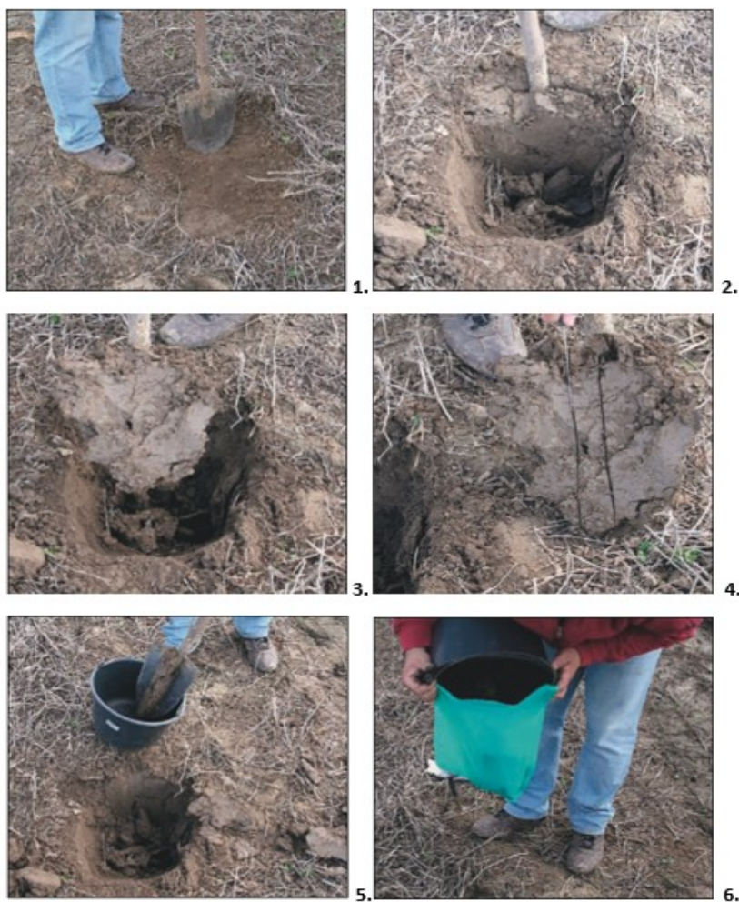
Slika 7. Uzorkovanje pojedinačnog uzorka štihačom (izvor: [33])
