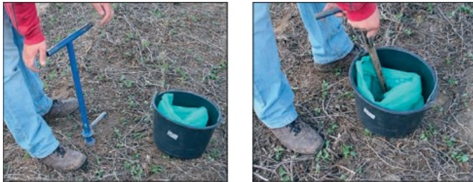
Slika 6. Uzorkovanje pojedinačnog uzorka tla sondom (izvor: [33])
