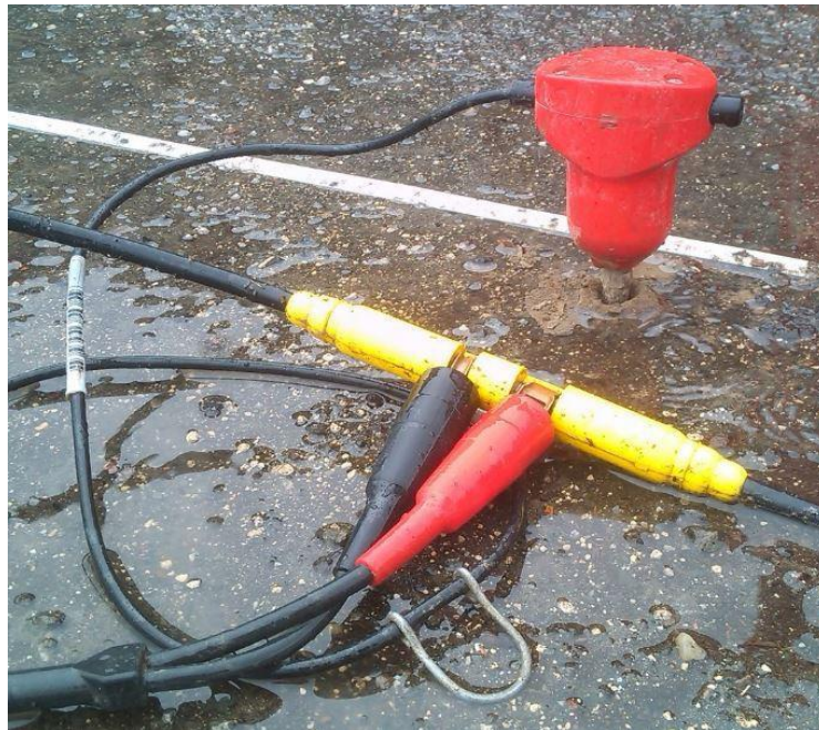
Slika 8 Vertikalni geofon niske frekvencije (4,5 Hz) [3]
