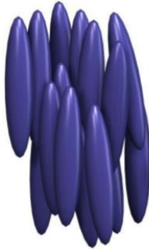
Slika 2. Tekući kristali u nematičkoj fazi [7]
