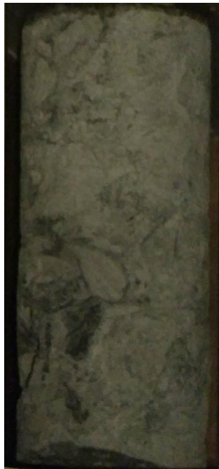
Slika 3.4. Brečasti dolomit, jezgra bušotine B-1, dubina 20-24 m
