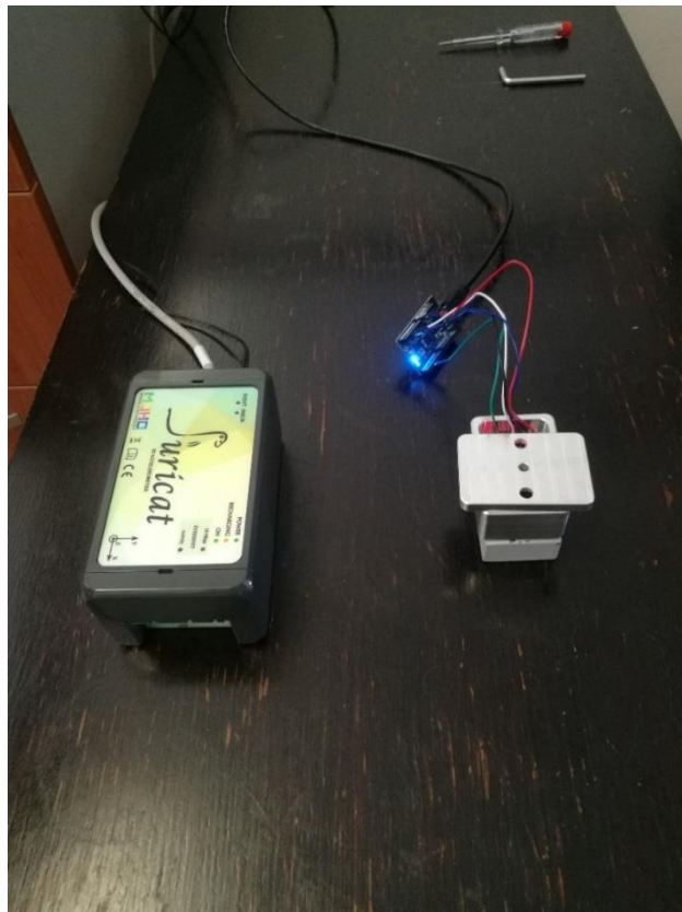
Slika 18. 3D akcelerometar Suricat i Croduino Basic2 povezan s MPU6050 senzorom (unutar kućišta)
