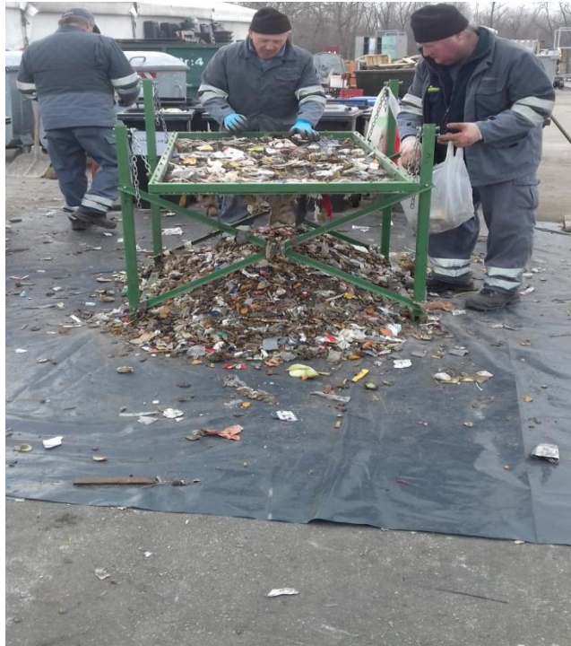
Slika 33 Sortiranje uzorka prema sastavnicama otpada
