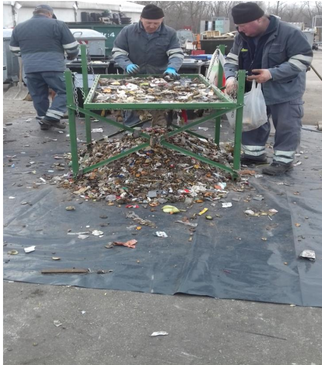
Slika 33 Sortiranje uzorka prema sastavnicama otpada
