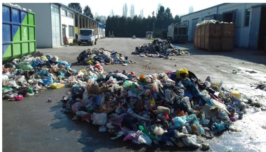
Slika 23 Prikaz četvrtanja otpada
