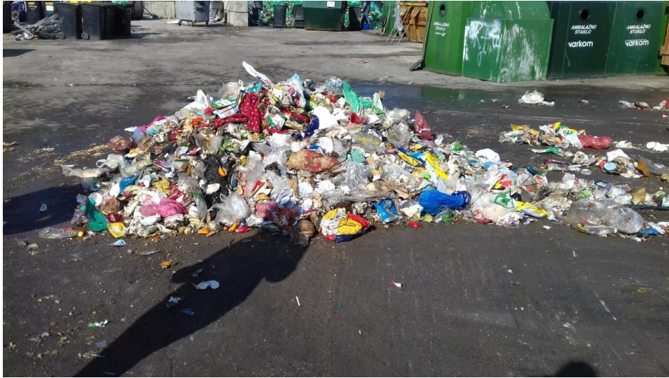
Slika 24 Prikaz reprezentativnog uzorka nakon četvrtanja
