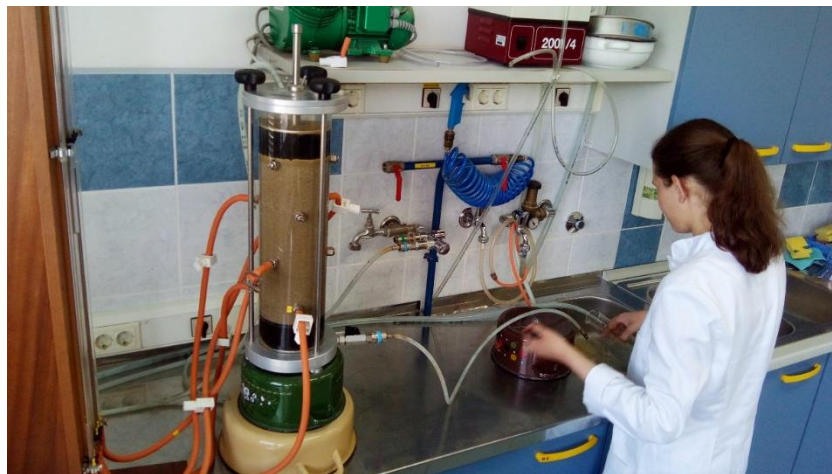
Slika 16. Ispitivanje u permeamtru sa stalnim potencijalom
