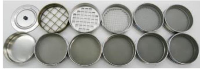
Slika 3. Sita s obzirom na veličinu otvora [9]
