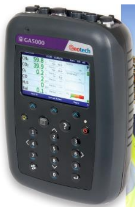
Slika 5. Instrument za mjerenje odlagališnih plinova [16]
