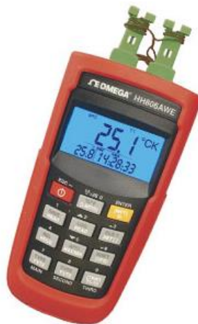
Slika 4. Temperaturni senzor OMEGA HH806AWE [15]
