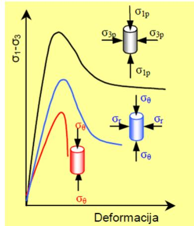
**Slika 3.4**Dijagram troosnog stanja naprezanja[14]
