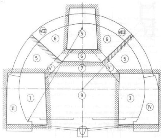
**Slika 2.3** Shematski prikaz redoslijeda radova kod Njemačke metode [1]
