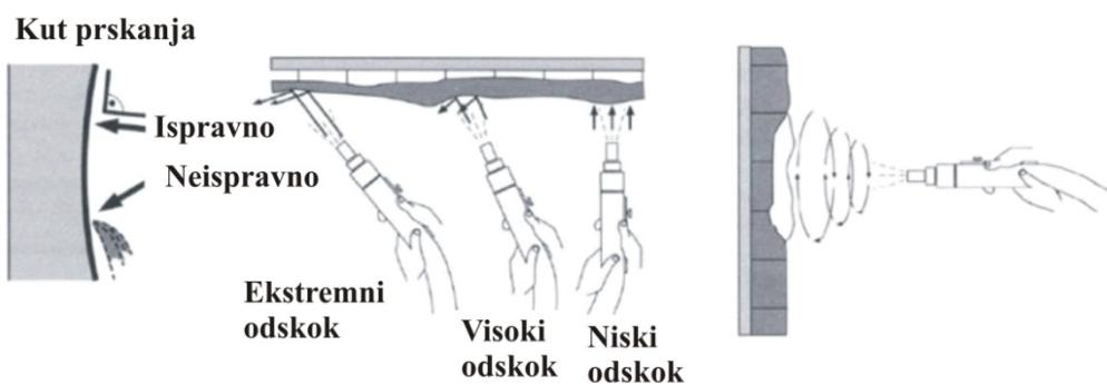
Slika 6.11 Pravilno prskanje kod ugradnje mlaznog betona [12]
