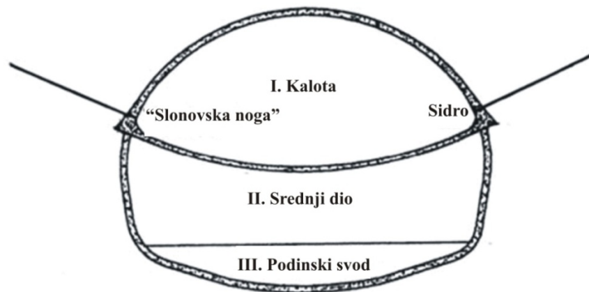
Slika 6.1 Iskop u tri faze [8]
