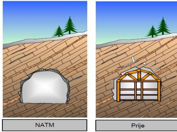
**Slika 3.10** Primjena mlaznog betona umjesto drvne podgrade[14]
