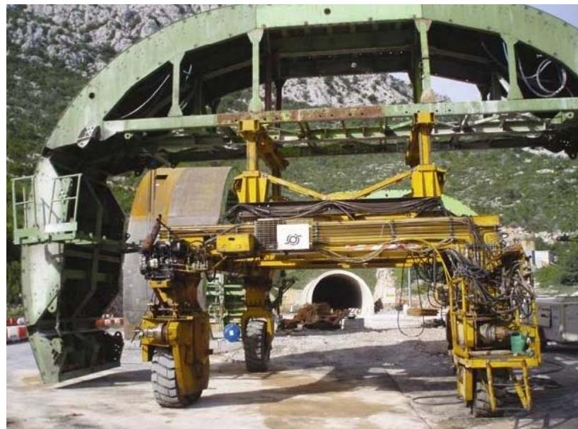
**Slika 9.8** Samohodna hidraulična oplata[10].
