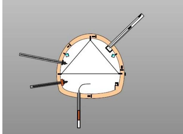
**Slika 3.13**Mjerenje pomaka konture iskopa[14]
