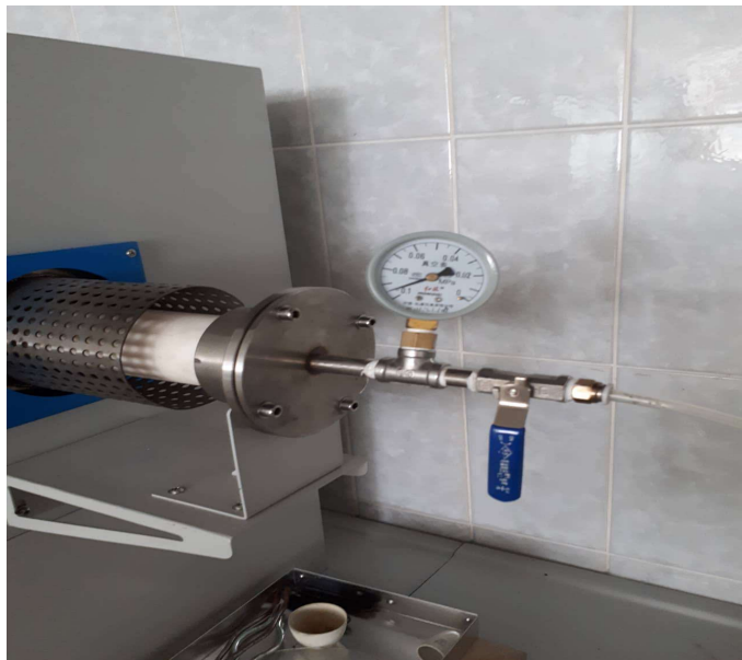
Slika 8: Ventil pomoću kojeg se upuhuje dušik
