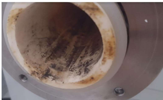
Slika 15: Vakuumska peć iznutra nakon eksplozije
