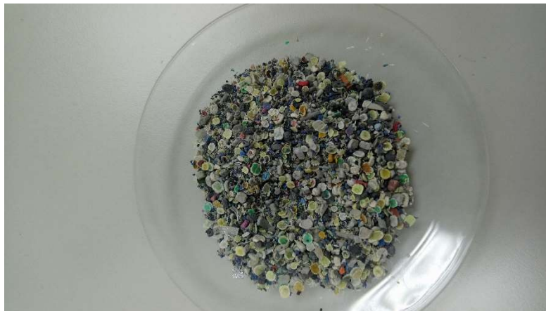
Slika 14: NMF tiskane pločice prije vakuumske pirolize
