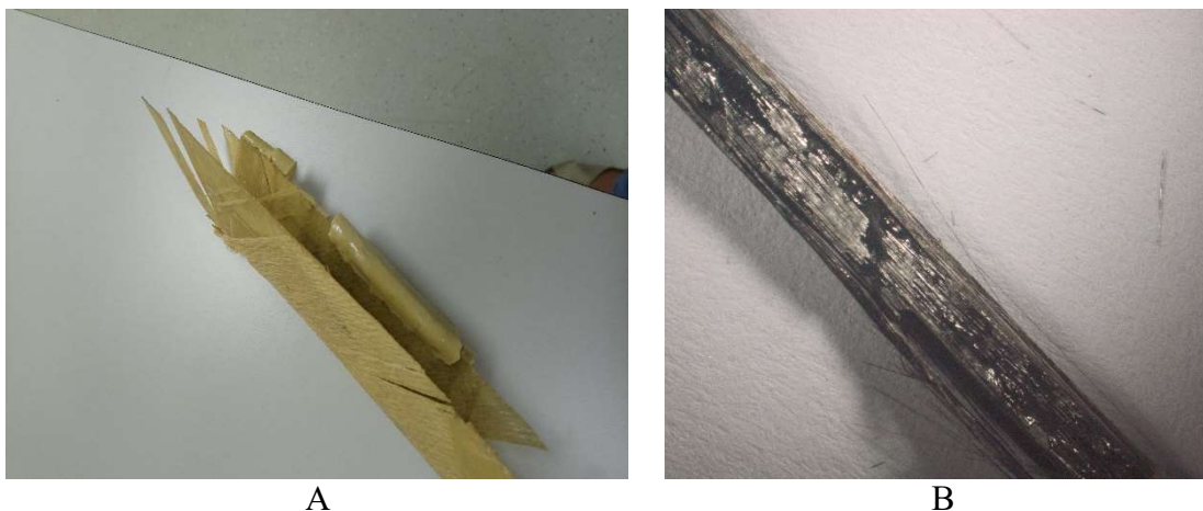
Slika 13: Uzorak stakloplastike prije (A) i nakon vakuumske pirolize (B)
