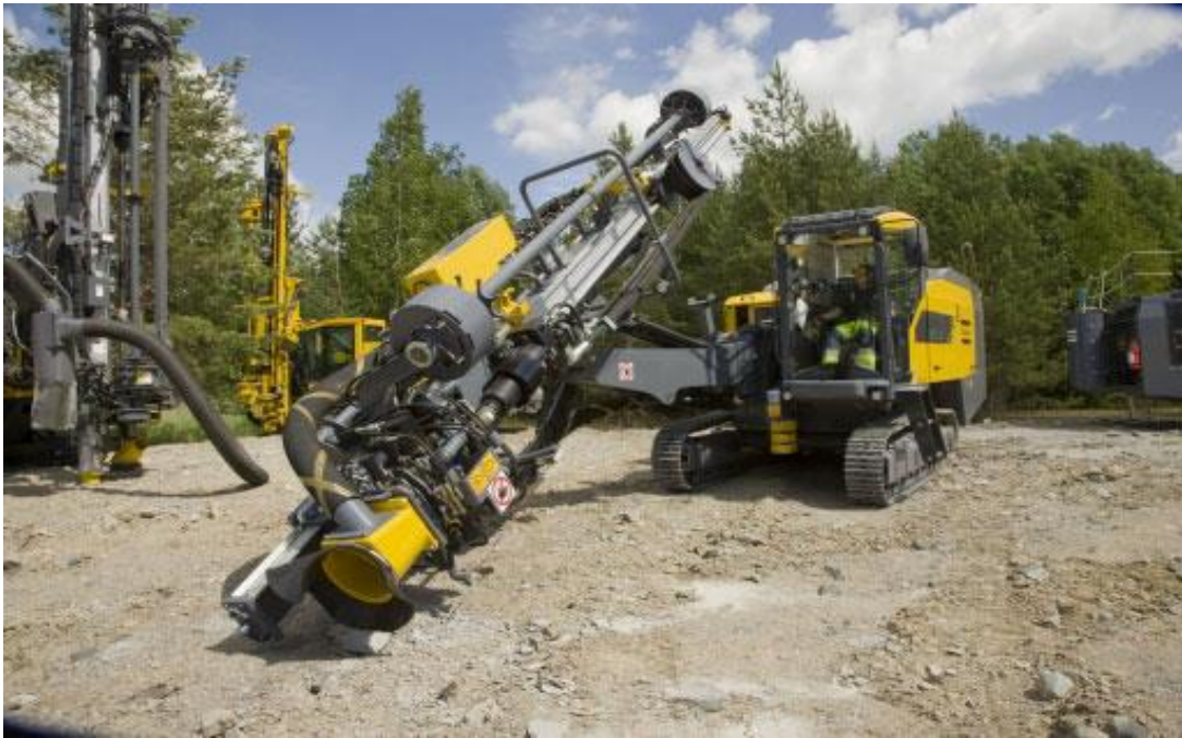
Slika 5.1 Udarno rotacijska bušilica s kompresorom [5]
