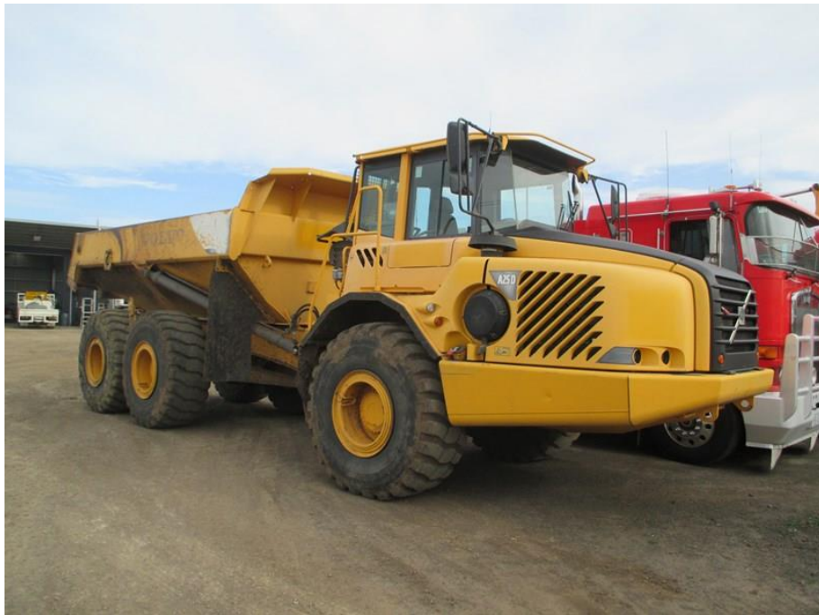
Slika 5.3 Kamion za transport unutar kamenoloma [2]
