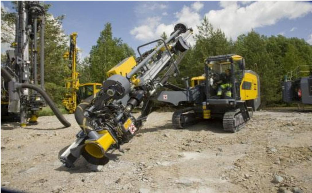
**Slika 5.1** Udarno rotacijska bušilica s kompresorom [5]
