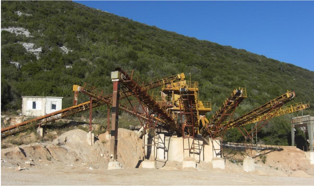
Slika 5.4 Postrojenje za oplemenjivanje kamena [10]
