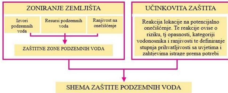
Slika 7. Shema zaštite podzemnih voda
