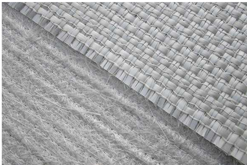
Slika 8. Podloga za fotokatalitički film
