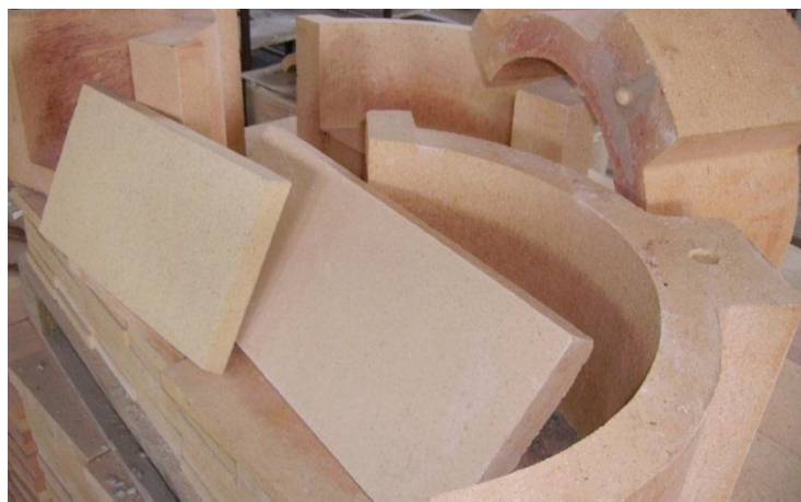
Slika 25. Gotovi proizvod izrađen od vatrostalne gline
