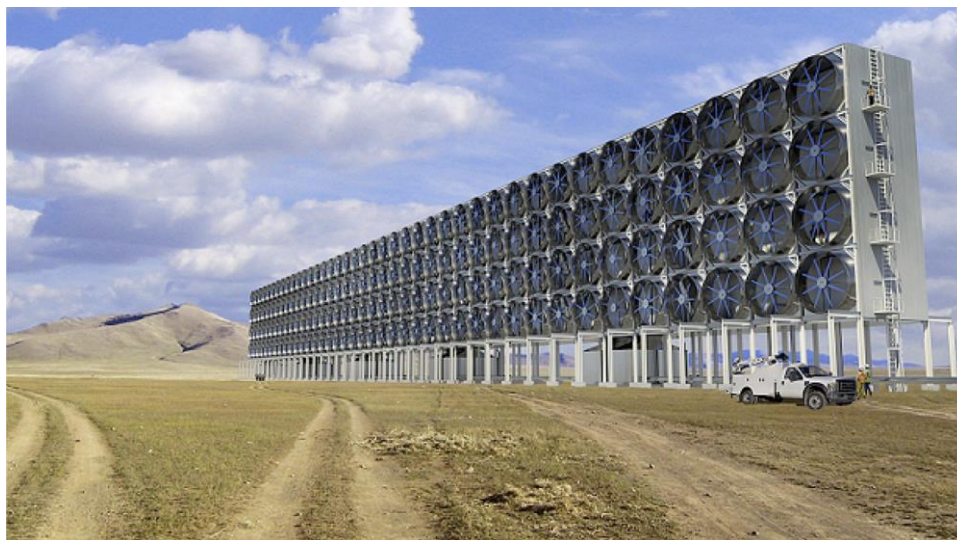
Slika 33. Uređaj za hvatanje zraka predložen od strane Carbon Engineering-a za direktno hvatanje ugljikovog dioksida iz zraka [30]
