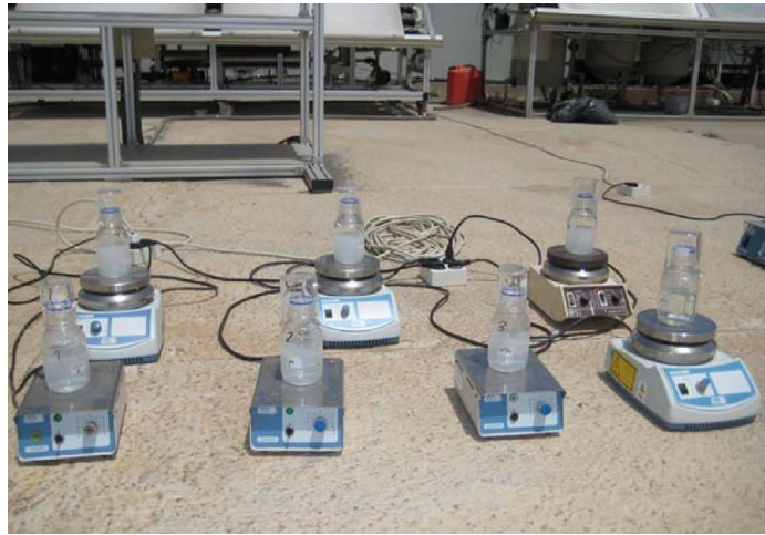
Slika 20. Fotokatalitička postava za inaktivaciju E. coli.[23]
