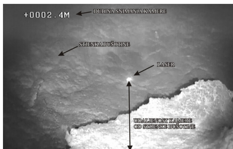
Slika 8.2 Snimak nastalog proširenja dubinskom kamerom.
