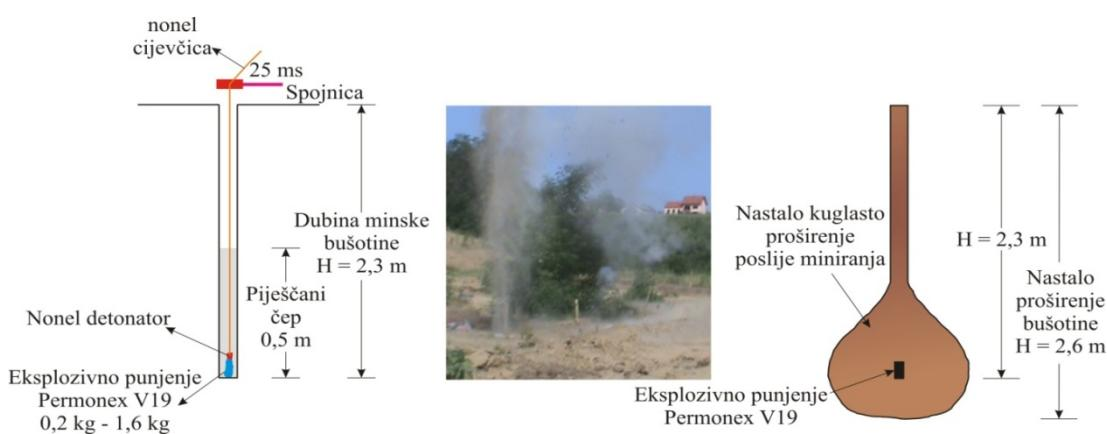
**Slika 7.4** Konstrukcija eksplozivnog punjenja minske bušotine
