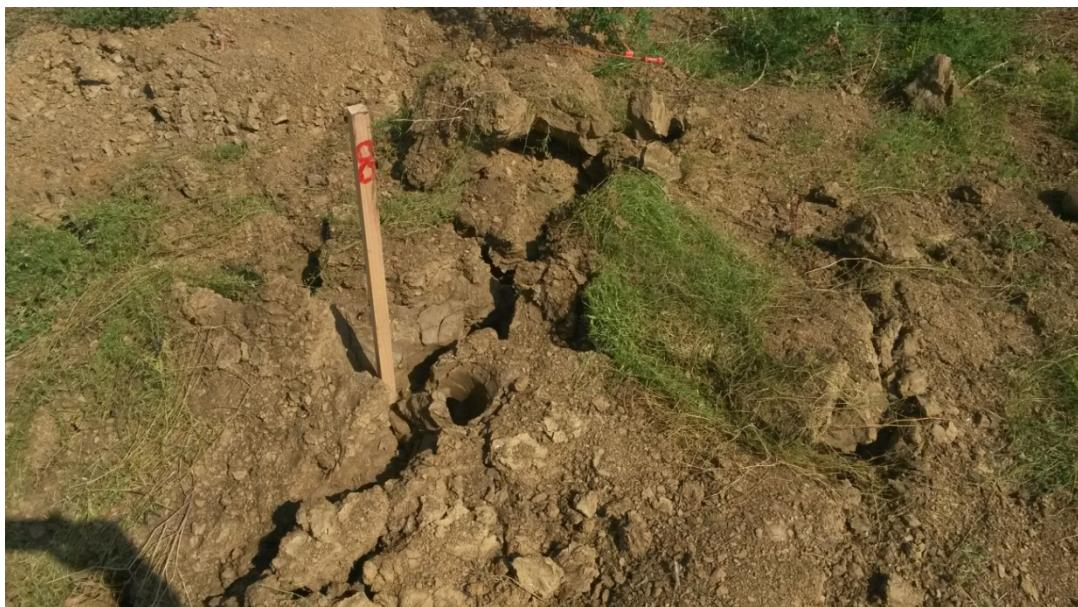
**Slika 7.7** Neželjeni lijevak u obliku kratera.
