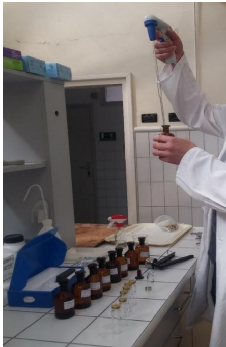
Slika 15. (a) Pipetiranje realnog uzorka iz Winklerice, (b) Pipetiranje realnog uzorka u vialu
