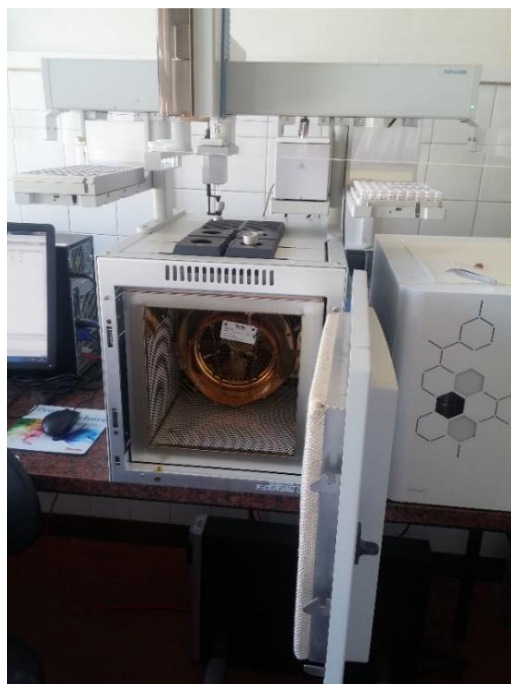
Slika 12. Kolona Rtx-502.2 smještena u termostatiranoj pećnici
