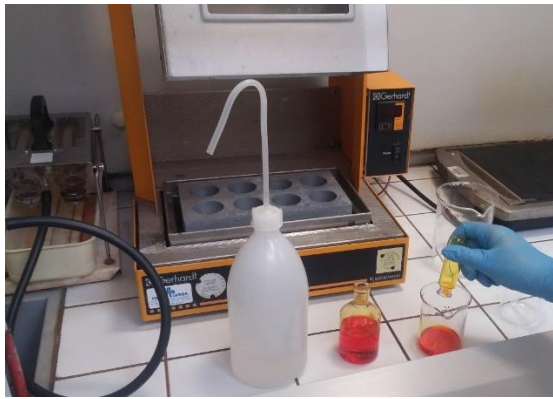
Slika 13. (a) Pranje viala kromsumpornom kiselinom, (b) Ispiranje viala ultračistom demineraliziranom vodom
