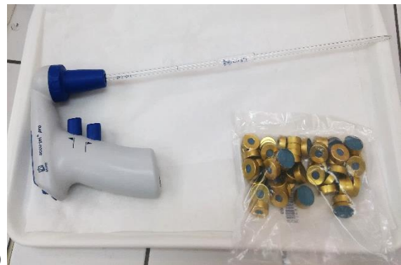
Slika 14. (a) Sušenje viala, (b) Automatska pipeta i čepovi sa septama
