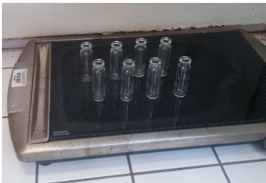
Slika 14. (a) Sušenje viala, (b) Automatska pipeta i čepovi sa septama
