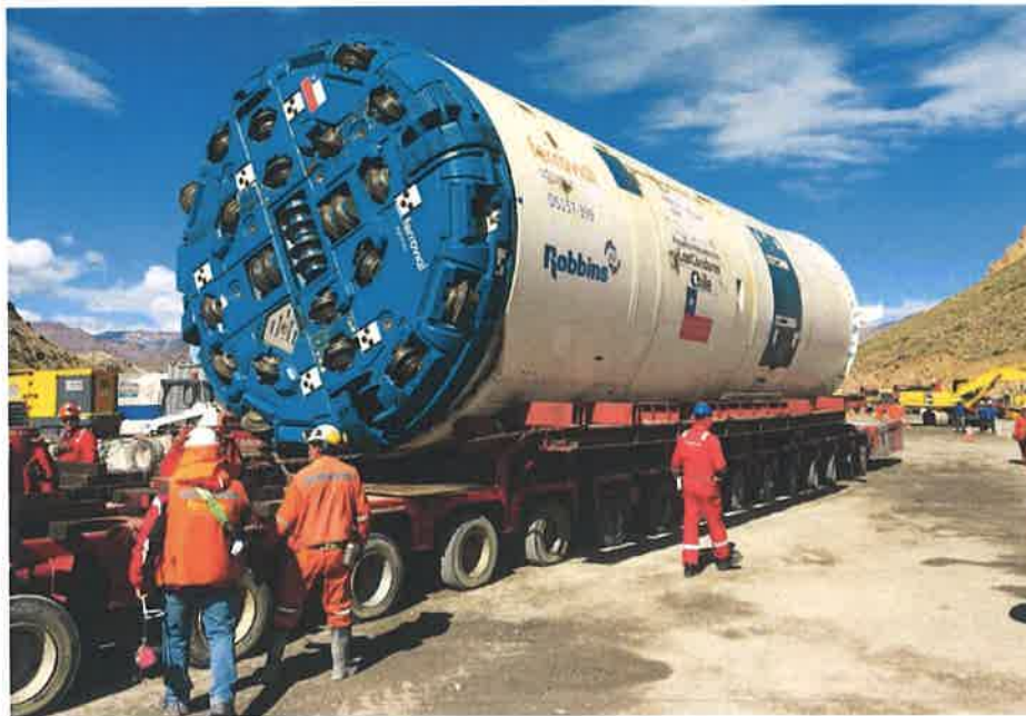
Slika 7.6. Stroj sa štitom [15].
