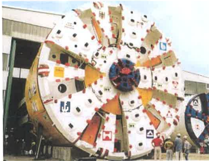
Slika 7.1. Stroj za iskop tunela u punom profilu [5].
