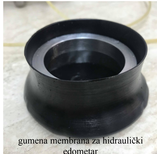
Slika 30 Usporedba gumenih membrani
