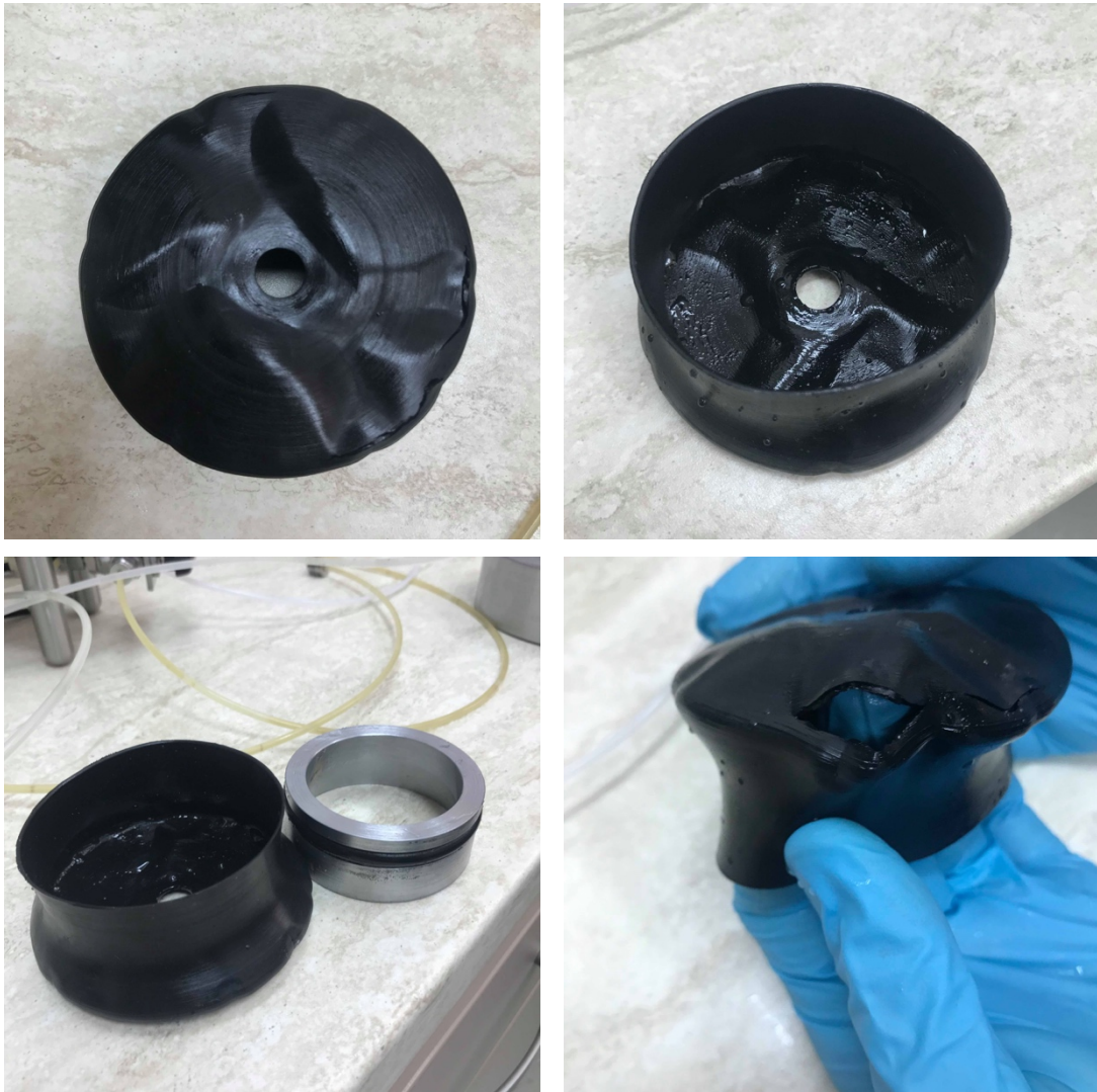
Slika 28 Deformacija i puknuće gumene membrane
