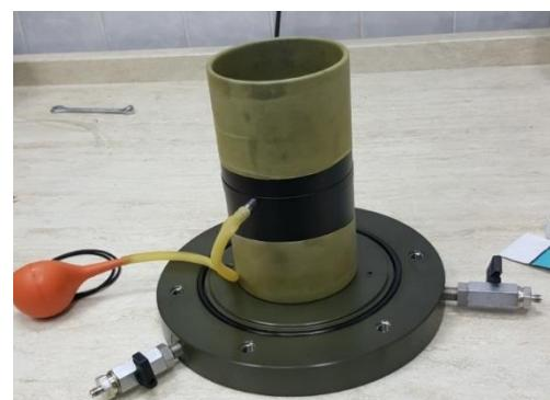
Slika 22. Pomoćni set za ugradnju rahlog uzorka
