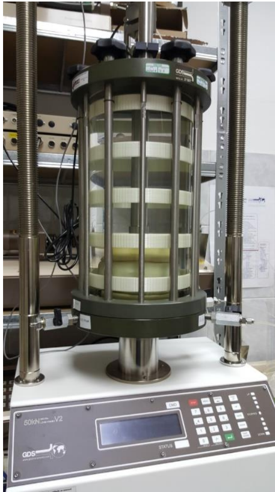
Slika 30. Uzorak nakon faze smicanja
