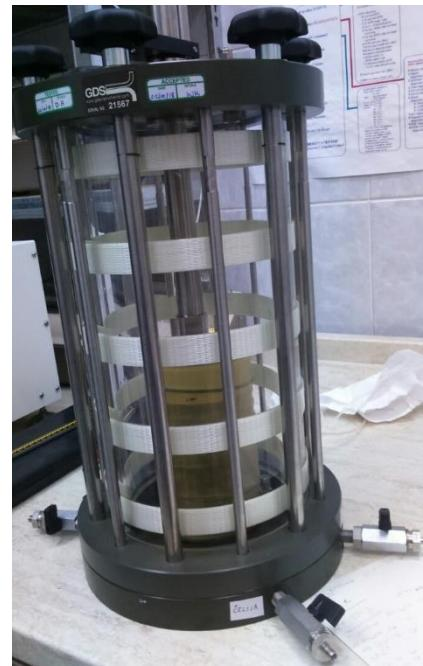
Slika 25. Ugrađen uzorak u triaksijalnoj ćeliji
