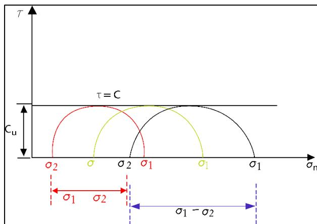
Slika 10. Rezultat nekonsolidiranog nedreniranog pokusa
