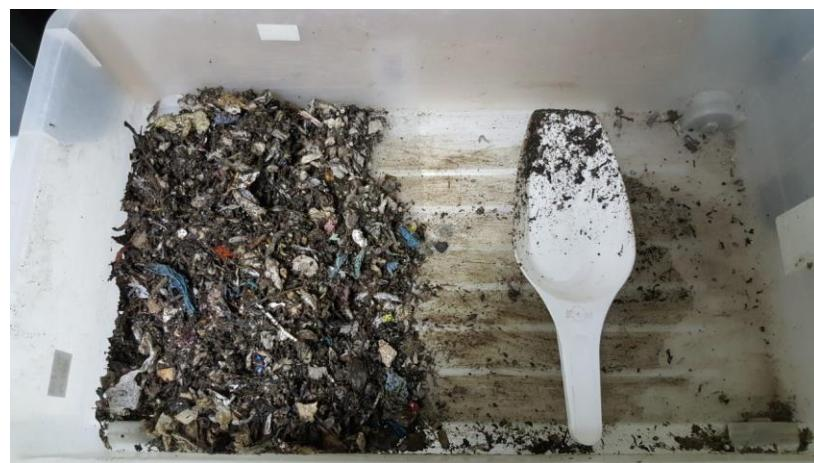
Slika 18. Homogenizacija uzorka
