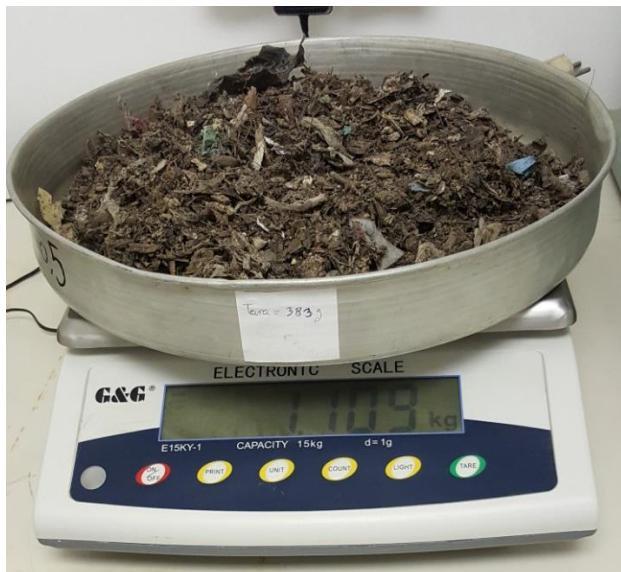
Slika 15. Vaganje posude i vlažnog uzorka
