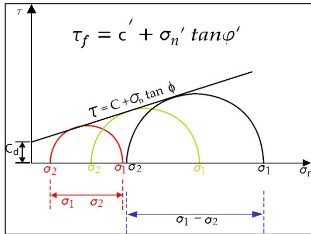
Slika 8. Rezultat konsolidiranog dreniranog pokusa
