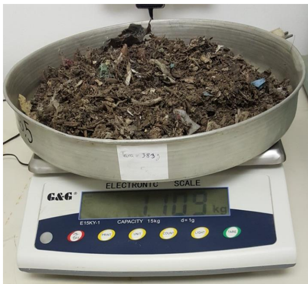
Slika 15. Vaganje posude i vlažnog uzorka
