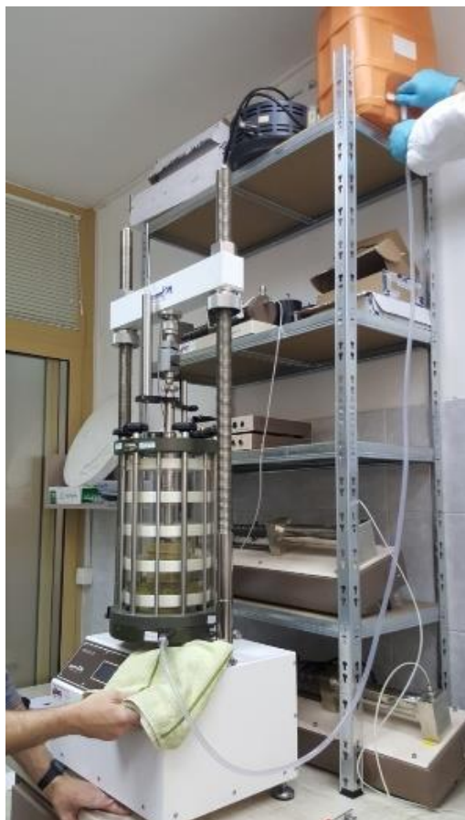
Slika 26. Punjenje ćelije vodom
