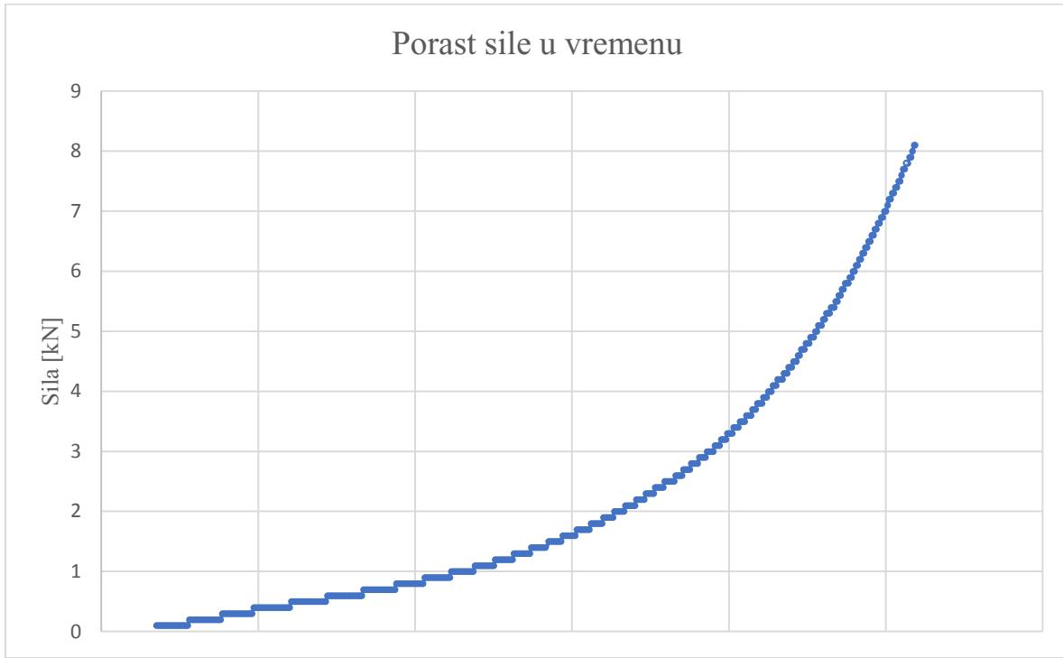
Dijagram 1. Porast vertikalne sile tijekom faze smicanja
