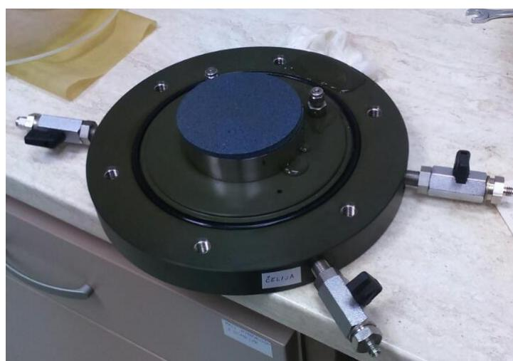
Slika 11b. Postolja za uzorak i čeliju triaksijalnog uređaja
