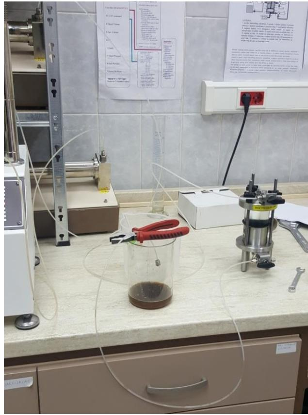
Slika 29. Toksična čelija i procjedna voda iz uzorka
