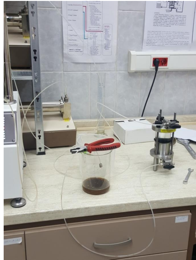
Slika 29. Toksična ćelija i procjedna voda iz uzorka
