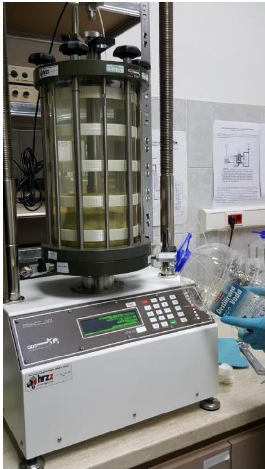
Slika 31. Ispuštanje vode iz čelije
