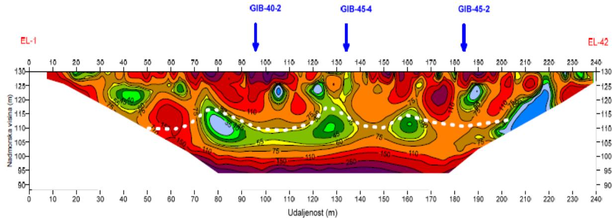
*Slika 6. 2D prikaz interpretiranog geoelektričnog profila GE-1*
