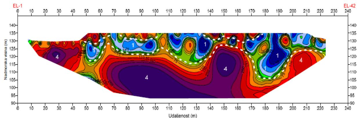
Slika 10. 2D prikaz interpretiranog geoelektričnog profila GE-5
