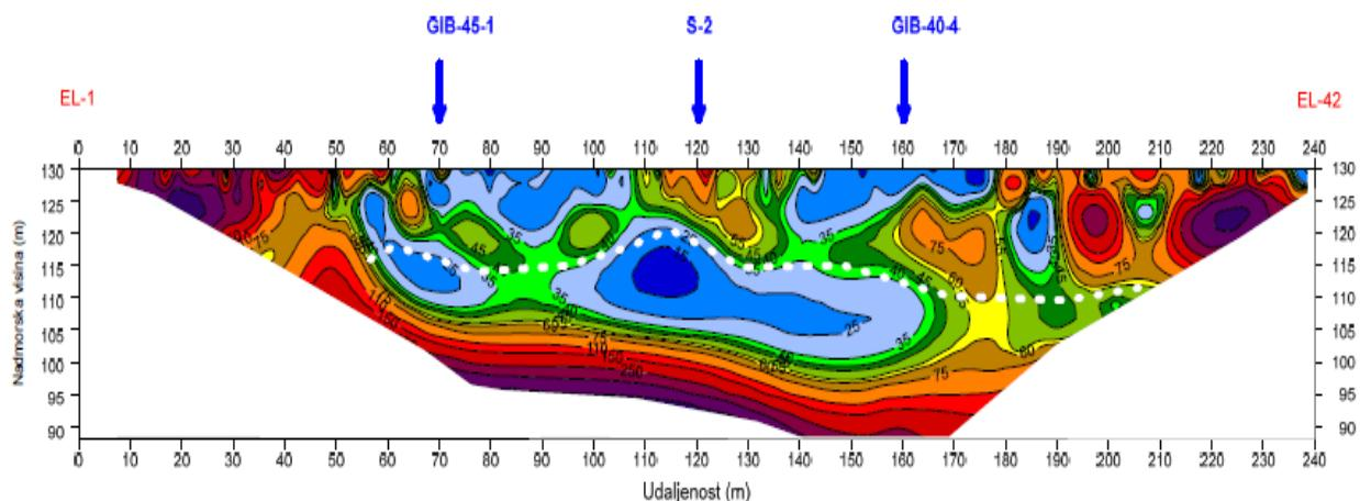
*Slika 7. 2D prikaz interpretiranog geoelektričnog profila GE-2*
