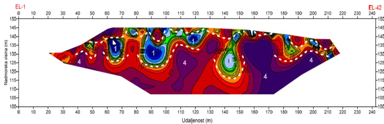
*Slika 11. 2D prikaz interpretiranog geoelektričnog profila GE-6*
