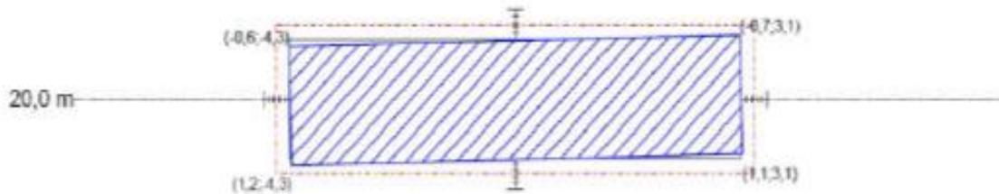
*Slika 20. Prikaz odstupanja iskopa od projektirane pozicije*
