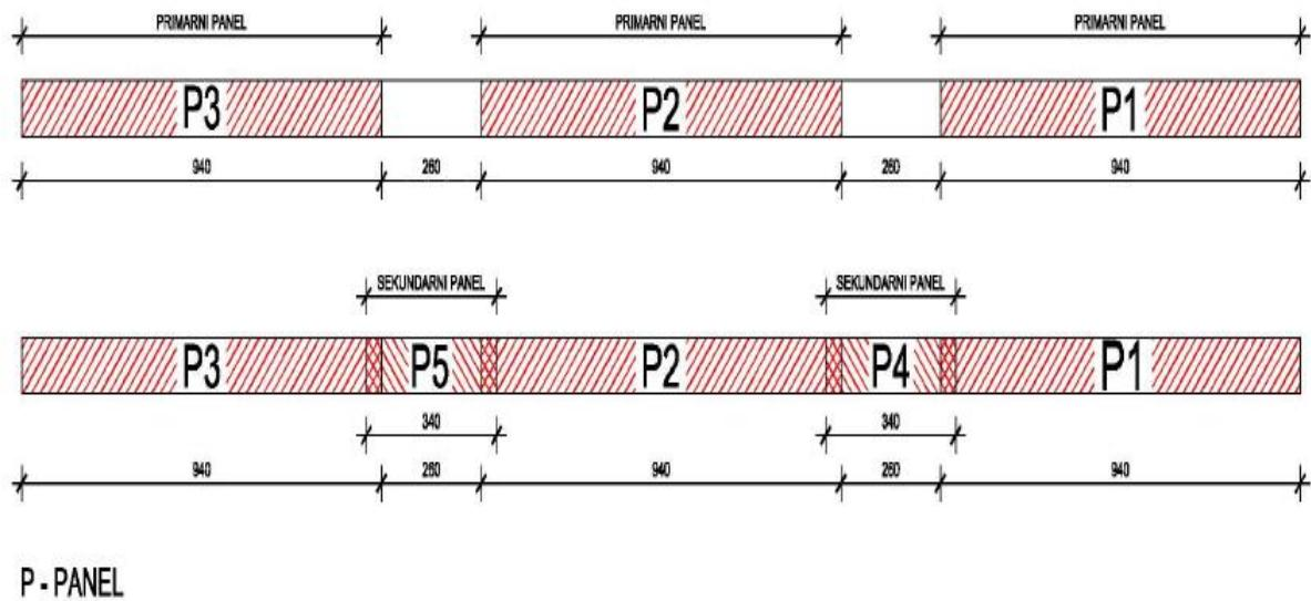
*Slika 18. Prikaz načina izrade sekundarnog panela duljine 2,60 m*
