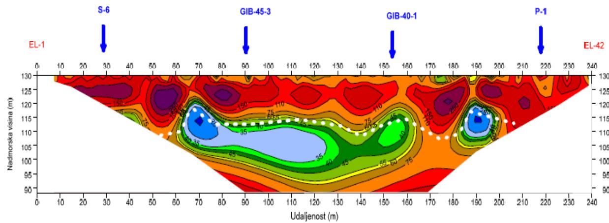
*Slika 8. 2D prikaz interpretiranog geoelektričnog profila GE-3*
