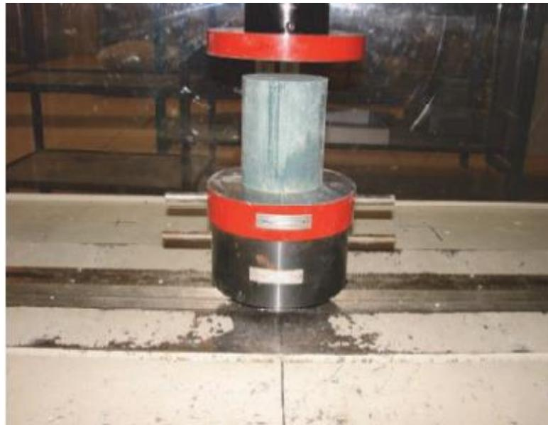
**Slika 26. Ispitivanje tlačne čvrstoće uzorka glinobetona [2]**
