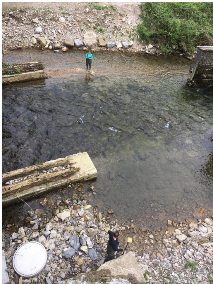
Slika 29. Geodetska izmjera korita na lokaciji Luke
