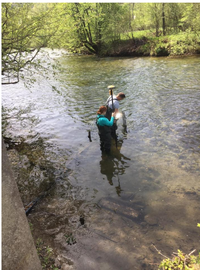
Slika 28. Geodetska izmjera korita na lokaciji Turkovići
