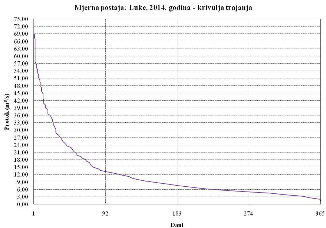
Slika P4-6. Grafički prikaz krivulje trajanja protoka na lokaciji Luke za 2014. godinu
