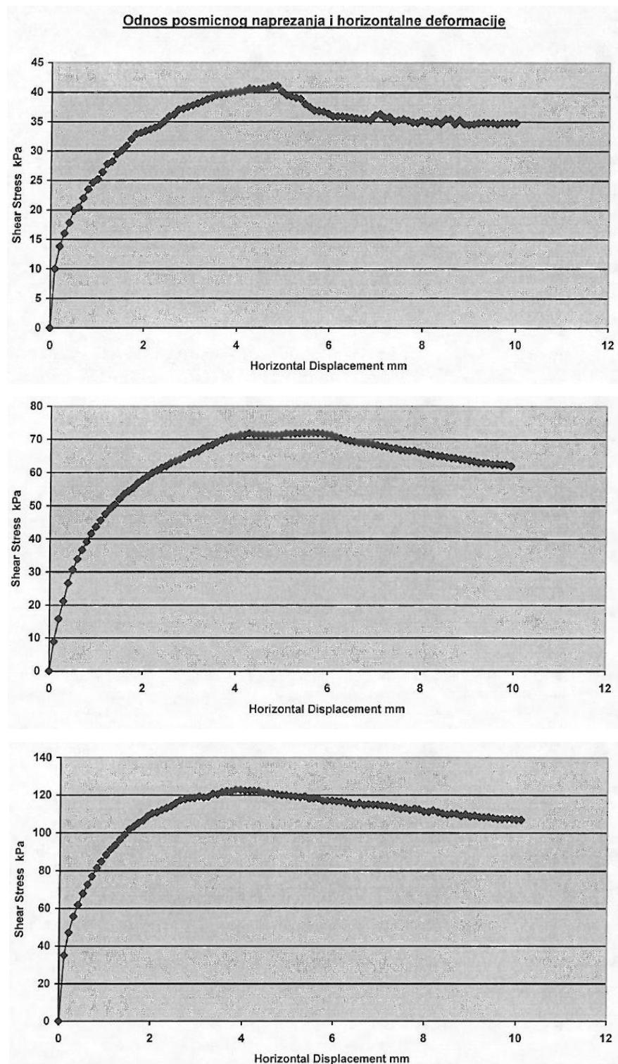
Slika 37. Odnos posmičnog naprezanja (Shear Stress) i horizontalne deformacije (Horizontal Displacement) na uzorku B-1 pod vertikalnim opterećenjem od 54,6; 109,2 i 2018,4 kN/m<sup>2</sup>
