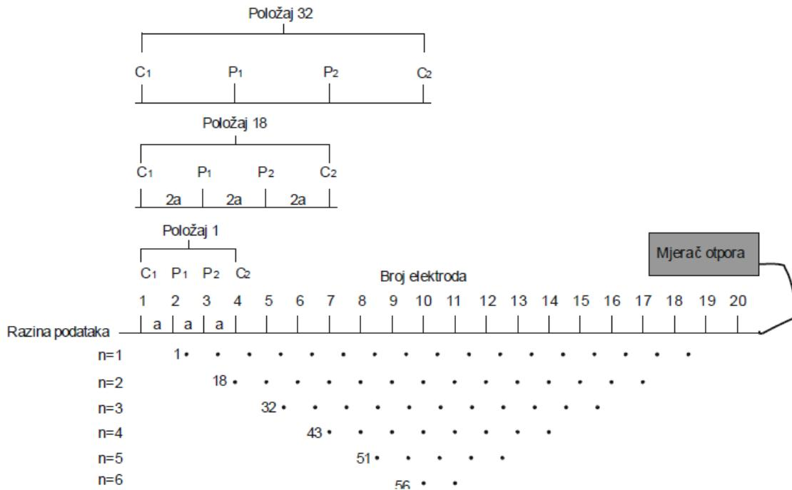
Slika 10. Raspored elektroda kod geoelektrične 2-D tomografije Wenner
