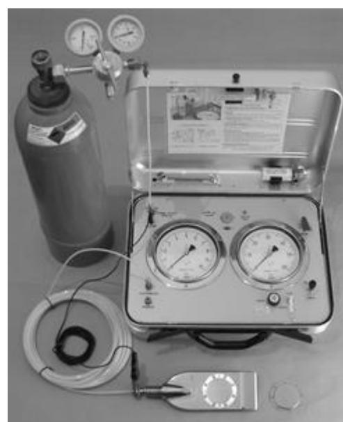
Slika 17. Oprema za dilatometar
