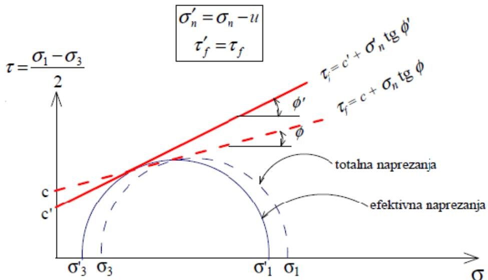
Slika 25. Mohr-Coulombov zakon čvrstoće za totalna i efektivna naprezanja
