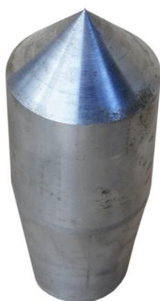
Slika 16. Šiljak DPL sonde (Szavits-Nossan, 2006)
