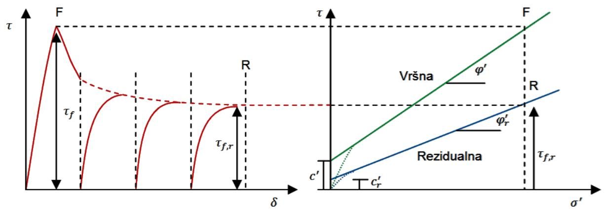
Slika 28. Rezultati reversnog pokusa izravnog posmika (Strelec, Štuhec, 2011)
