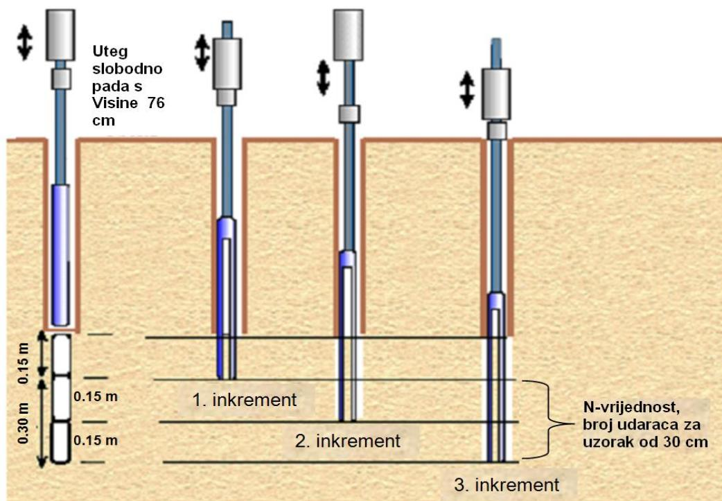
Slika 15. Postupak ispitivanja standardnim penetracijskim pokusom (Roje-Bonacci, 2012)
