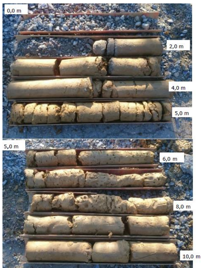
Slika 32. Prikaz sondažne jezgre bušotine B-2
