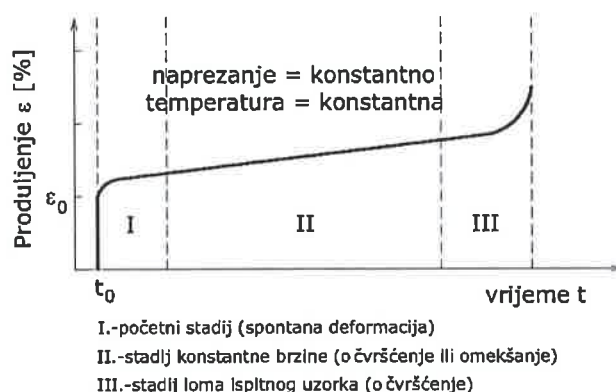
Slika 6. Dijagram deformacije plastike uslijed povećanja temperature
