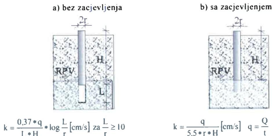
Slika 13. Mjerjenje vodopropusnosti metodom Lefranc sa stalnim padom
