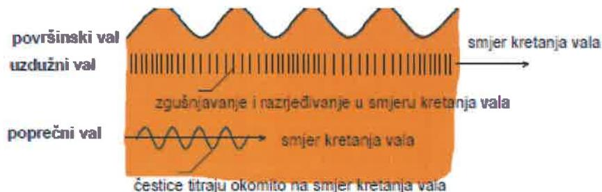
Slika 24. Vrste mehaničkih valova u tlu
