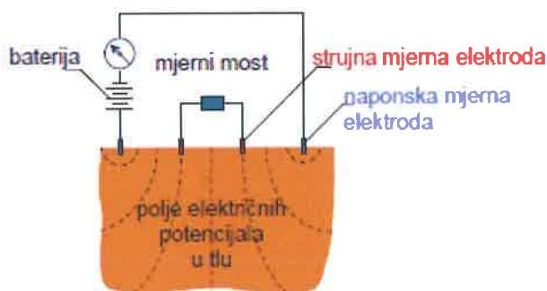
Slika 21. Shema geoelektričnih mjerena
