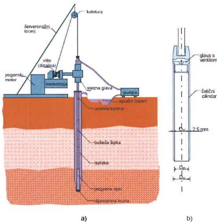
Slika 7. Vađenje uzoraka iz bušotine
