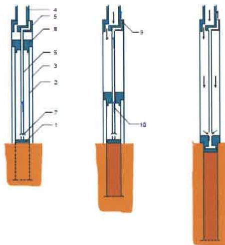
Slika 8. Cilindar s fiksnim klipom za vađenje neporemećenih uzoraka
