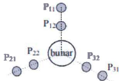
Slika 14. Tlocrtni položaj bunara i piezometara za mjerjenje vodopropusnosti
