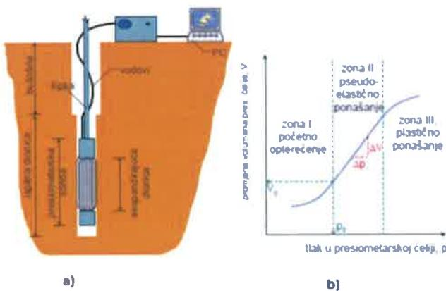
Slika 18. Shema mjerena presiometrom (a) i dijagram opterećivanja (b)
