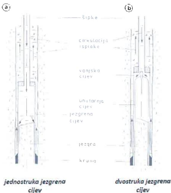
Slika 9. Prikaz a) jednostrukе jezgrene cijevi, b) dvostrukе jezgrene cijevi (Meaški, 2018)
