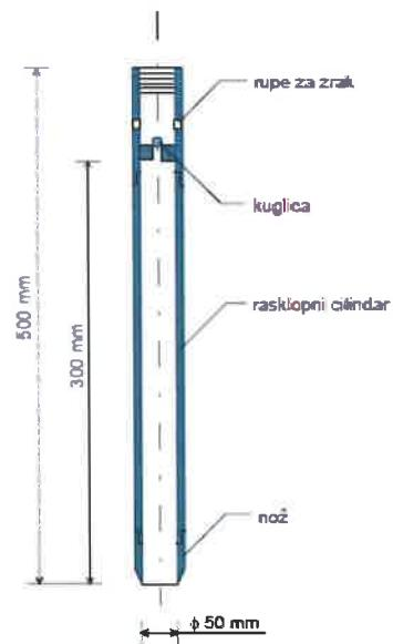
**Slika 16. Cilindar za SPP**
