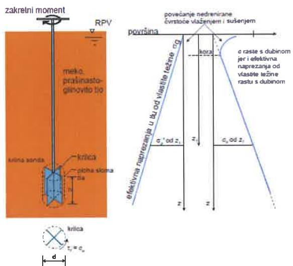
Slika 17. Prikaz krilne sonde i rezultata ispitivanja
