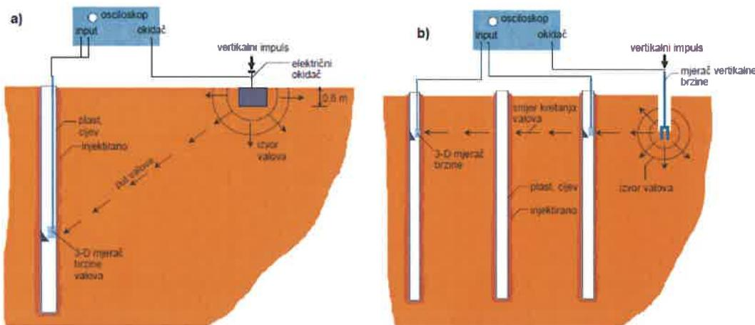
Slika 27. Cross-hole (a) i down-hole (b) mjerjenje brzine nailaska valova
