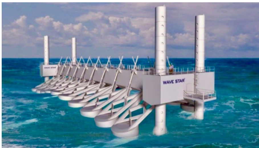
Slika 5. Sustav za pretvaranje energije valova u električnu [13]
