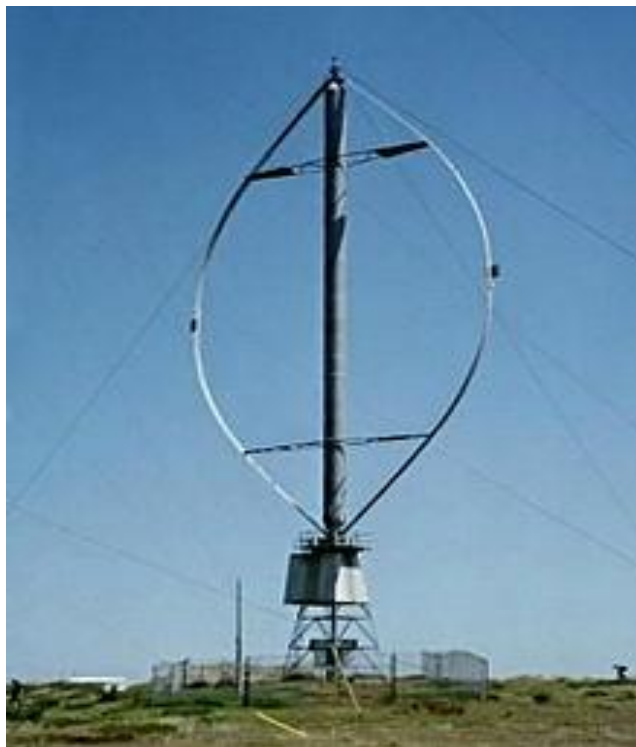
Slika 9. Vjetroelektrana s okomitim rotorom [21]
