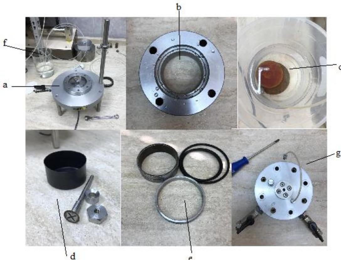
Slika 13 Dijelovi hidrauličkog edometra
