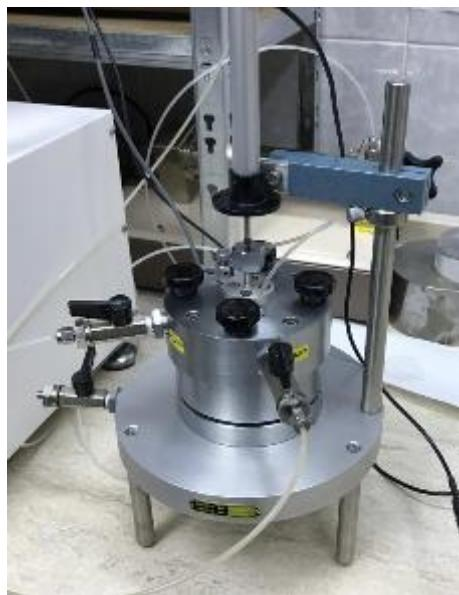
Slika 11 Hidraulički edometar
