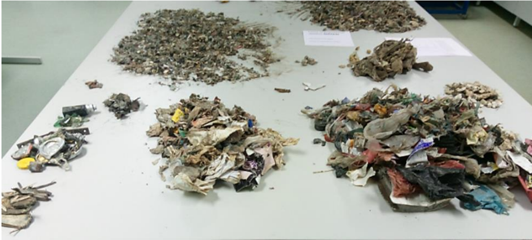
Slika 3.3.: Razdvajanje uzorka komunalnog otpada iz ŽCGO Kaštijun na komponente
