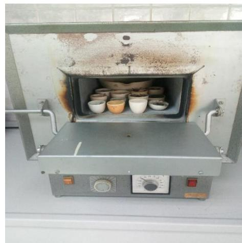
Slika 18. Peć za žarenje (Mufolna peć)
