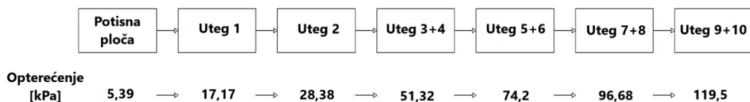
Slika 21. Postupak opterećenja uzorka
