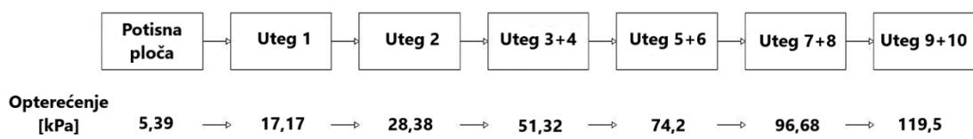
Slika 21. Postupak opterećenja uzorka
