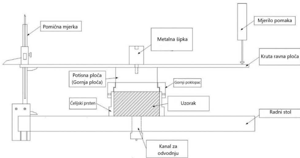
Slika 13. Shema edometra s mjernim sklopolom
