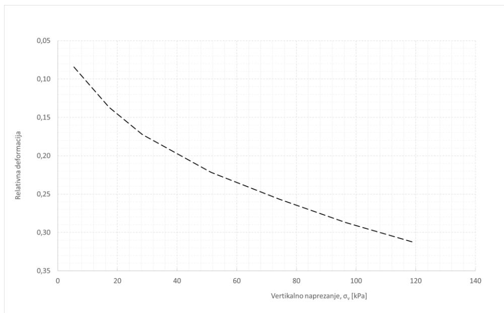
Slika 24. Krivulja relativne deformacije za ispitivani uzorak
