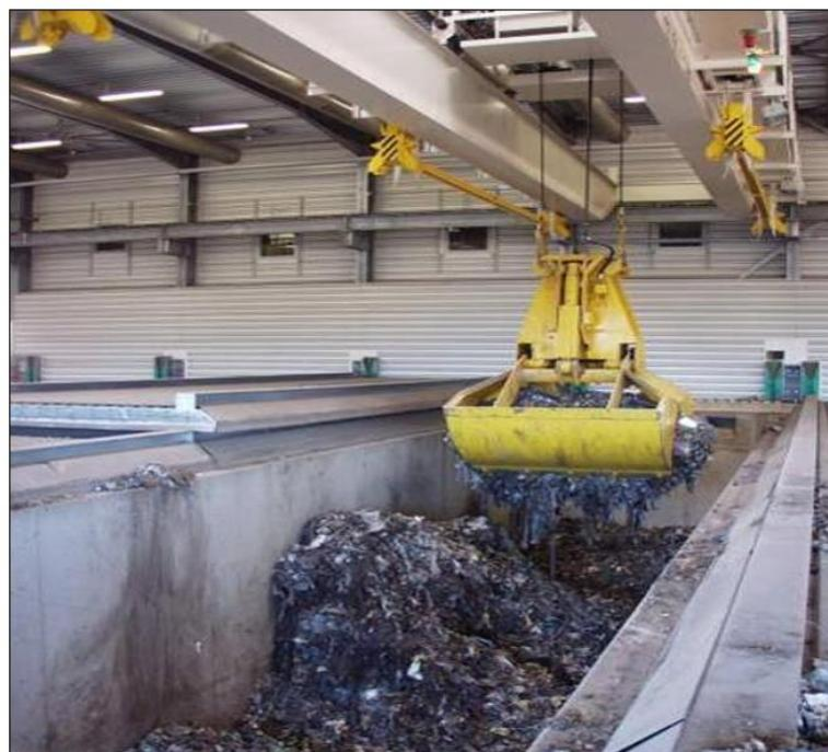
Slika 2. Procesni kran utovaruje komoru za biološko sušenje
