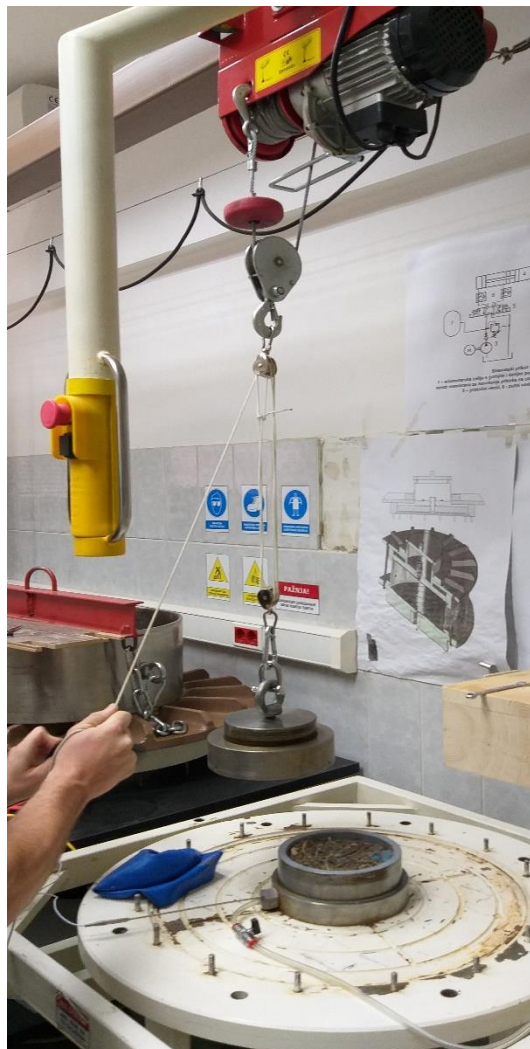
Slika 14. Kolotur koji se koristi za postavljanje potisne ploče i utega
