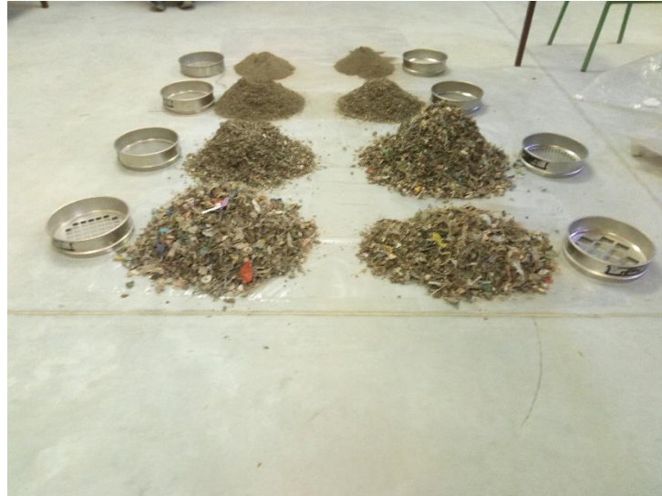
Slika 16. Dobivene frakcije nakon prosijavanja
