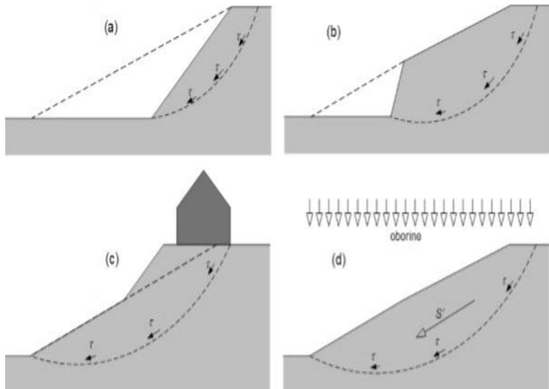
*Slika 7. Uzroci povećanja posmičnih naprezanja na kliznom tijelu [1]*
