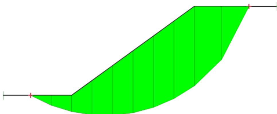
*Slika 14. Prikaz kosine podijeljene na lamele [11]*
