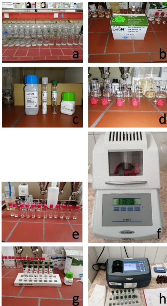
Slika 9. Koraci u provođenju kivetnog testa: (a) Prikupljeni uzorci površinskih voda u staklenim bocama, (b) Kivetni test LCK 138, (c) Korišteni reagensi iz kivetnog testa LCK 138, (d) Priprema reakcijskih epruveta, (e) Reakcijske epruveta sa izmjerenom količinom uzorka, (f) Zagrijavanje reakcijskih epruveta u termoreaktoru, (g) Kivete spremne za očitavanje na spektrofotometru, (h) Očitavanje ukupnog dušika na spektrofotometru.
